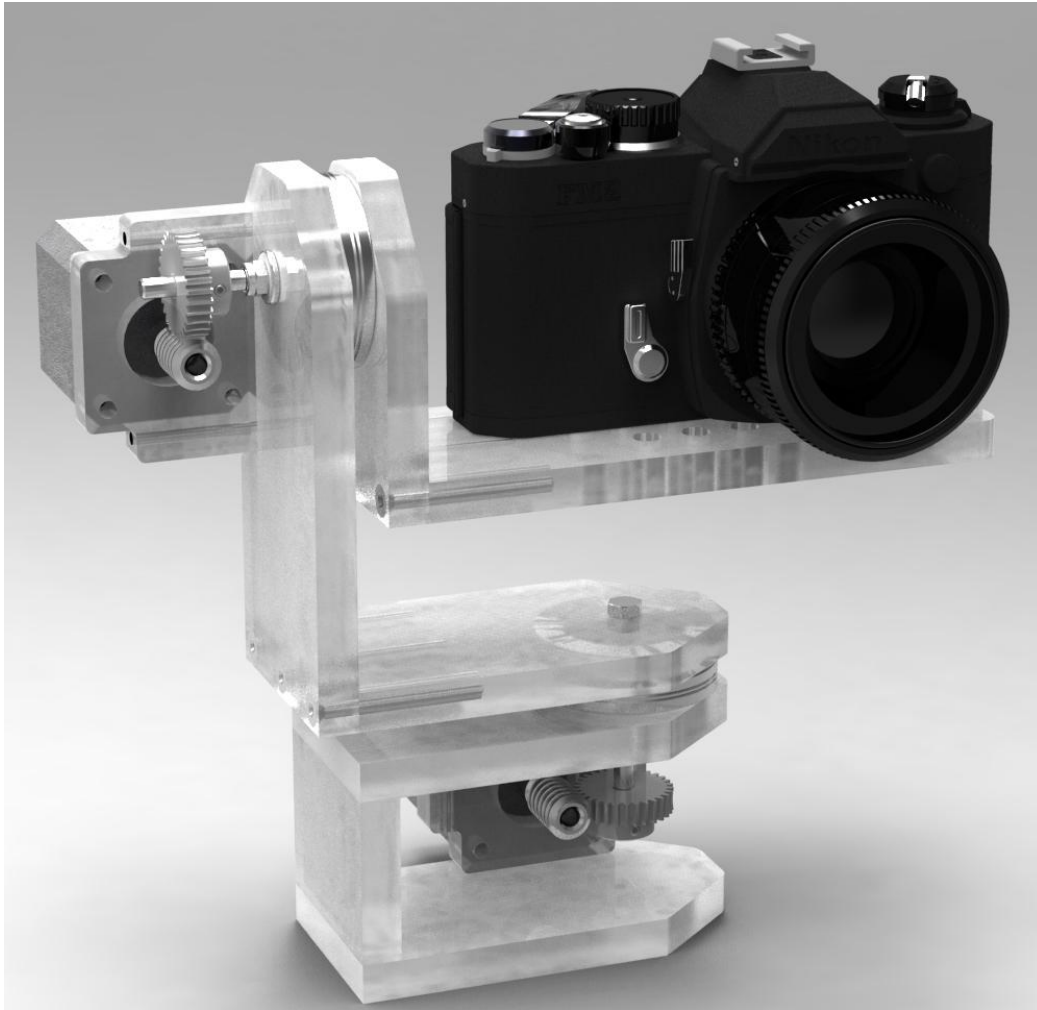
Φωτογραφία 1.5: Μηχανισμός pan & tilt με την χρήση δυο βηματικών κινητήρων
