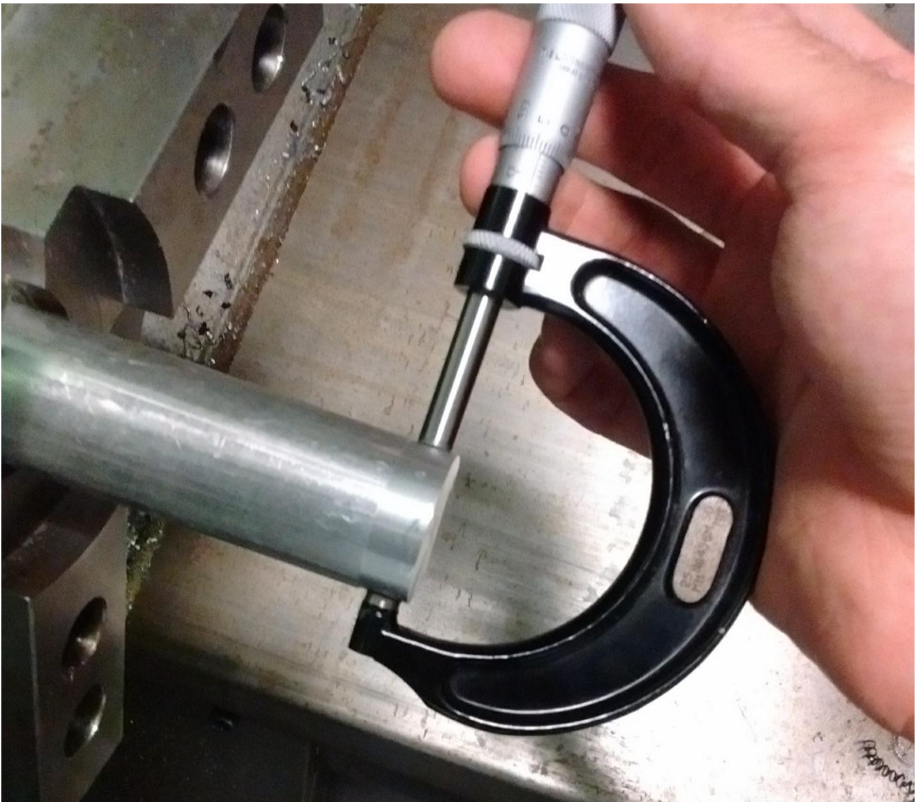
Φωτογραφία 3.6: Μέτρηση της διαμέτρου για την διαδικασία μηδενισμού του τεμαχίου στον CNC τόρνο.
