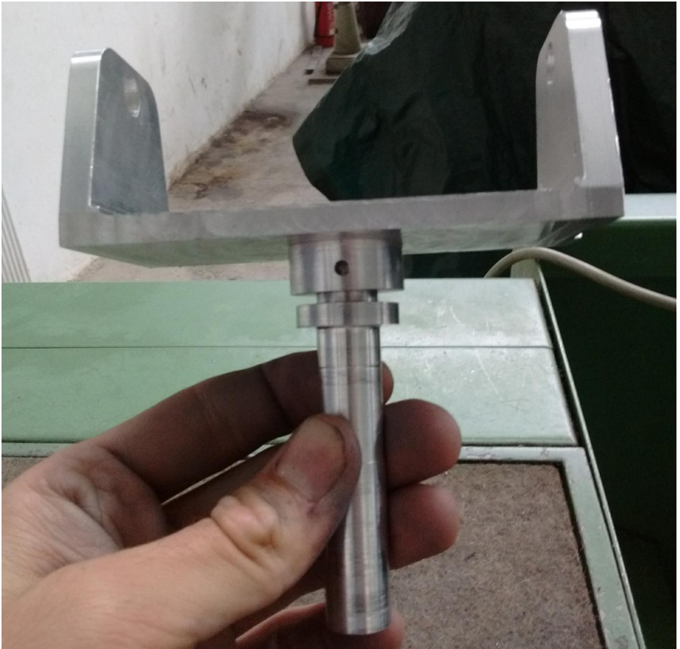
Φωτογραφία 3.17: Φωτογραφία κατά την διάρκεια της συναρμολόγησης του κεντρικού άξονα με την βάση
