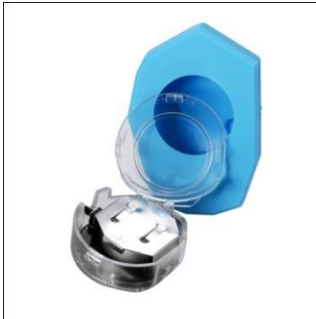
Εικόνα 30 - SKYBEACON, τα beacons που χρησιμοποιήσαμε στην υλοποίησή μας
