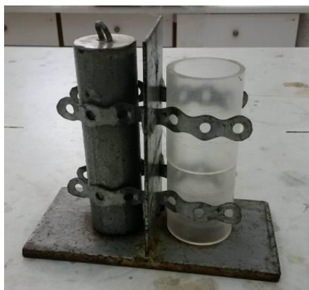
Εικόνα 12: Εξοπλισμός που χρησιμοποιείται για την επίτευξη κορεσμού των δειγμάτων. Χαρακτηριστικά κάτω κύλινδρου, εσωτ. Διάμετρος 42mm και ύψος 58mm ( 80\text{cm}^3 ) και βαρίδιο για τη συμπίεση των δειγμάτων
