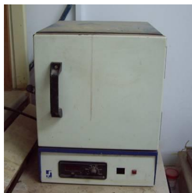
Εικόνα 17: Φούρνος καύσης (550°C) εργαστηρίου TEI Κρήτης
