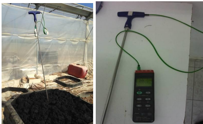
Εικόνα 10: Θερμόμετρο και μέτρηση θερμοκρασίας υλικού κομποστοποιητή
