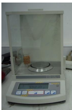
Εικόνα 16: Ζυγός ακριβείας εργαστηρίου TEI Κρήτης (μέχρι τέσσερα δεκαδικά ψηφία)
