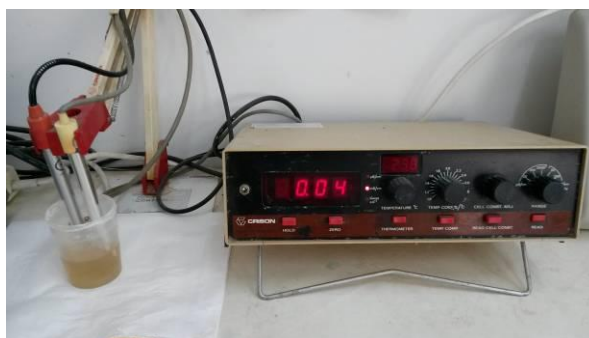
Εικόνα 15: Αγωγιμόμετρο εργαστηρίου ΤΕΙ Κρήτης
