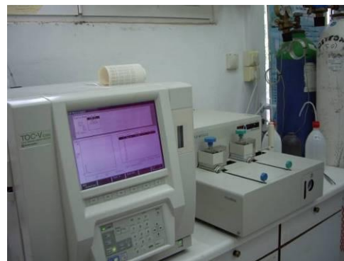
Εικόνα 18: Μηχάνημα μέτρησης TOC, εργαστηρίου ΤΕΙ Κρήτης
