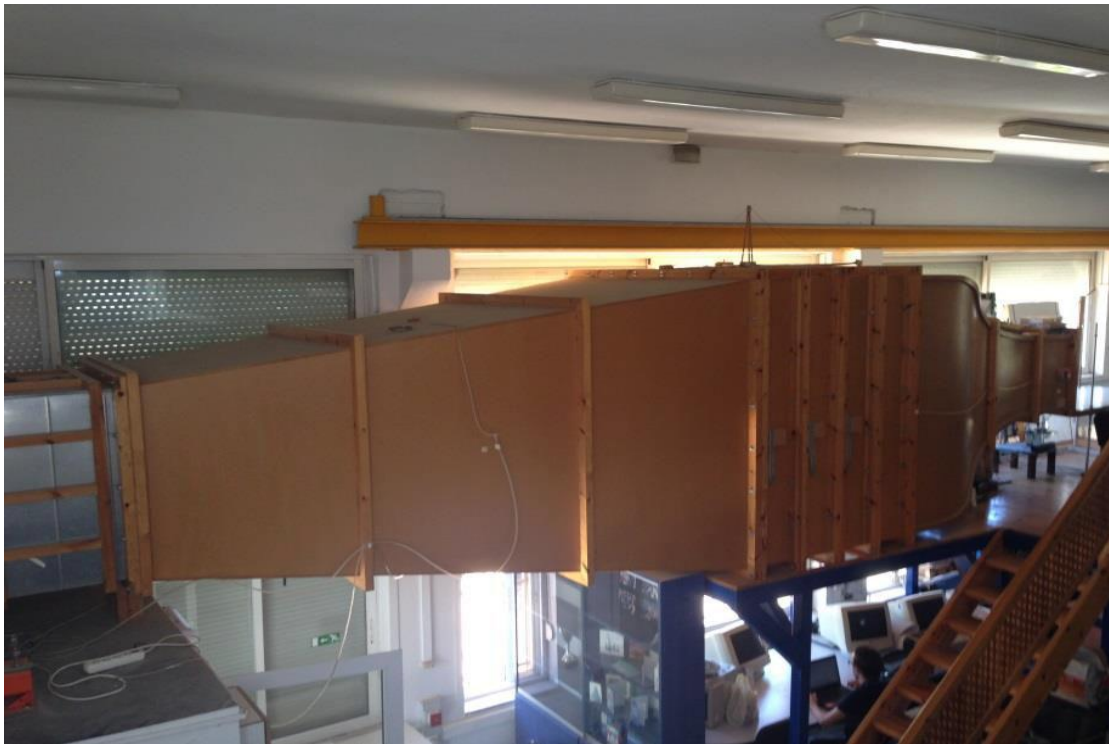
Εικόνα 16: Η αεροσήραγγα του εργαστηρίου
