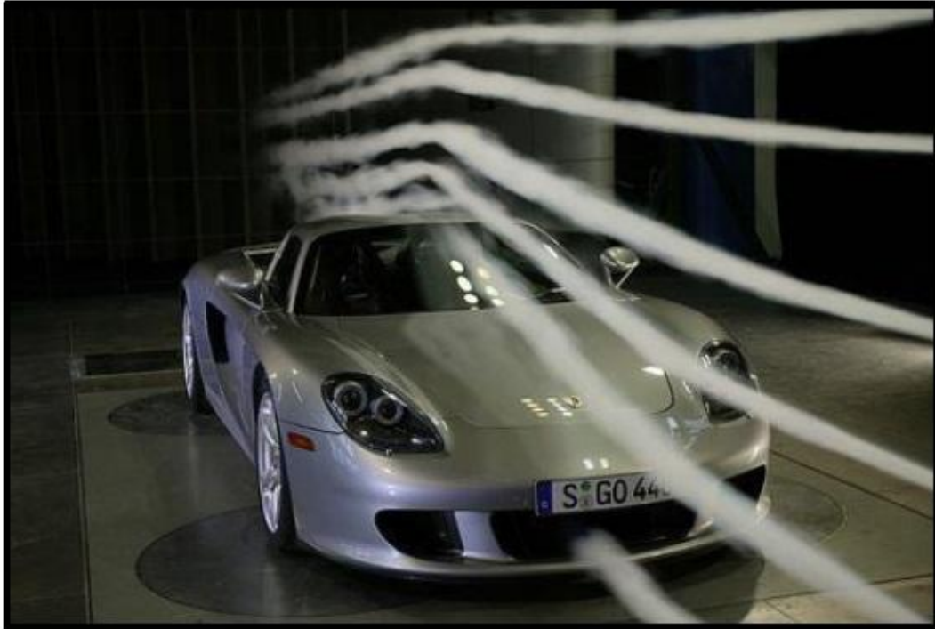
Εικόνα 10: Εμφάνιση γραμμών ροής με χρήση καπνού.
