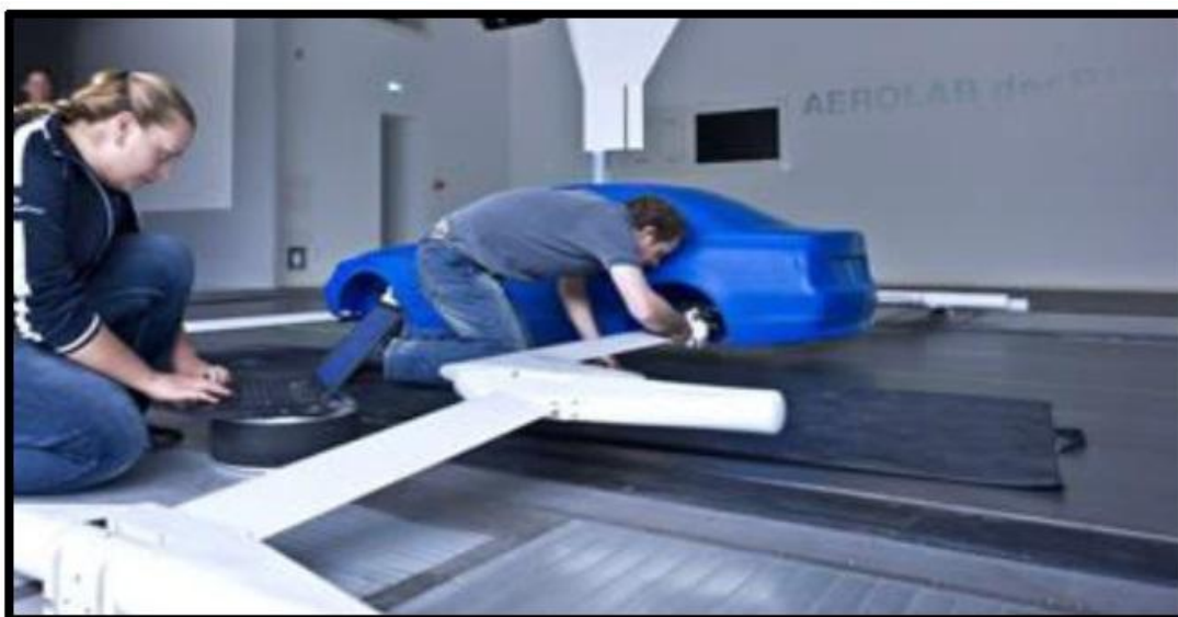
Εικόνα 8: Κατασκευή μοντέλου για αεροδυναμικές μετρήσεις.
