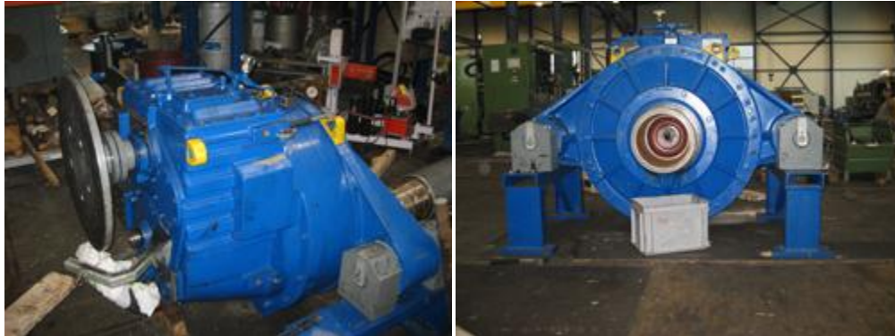
Εικόνα 4.3.8: Το κιβώτιο ταχυτήτων κατά την άφιξη του στο συνεργείο όπου γίνεται η επισκευή του.[12]
