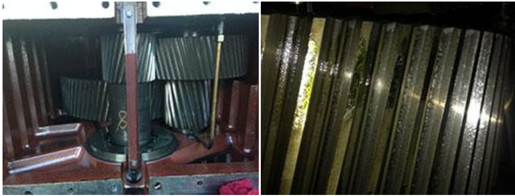
Εικόνα 4.3.13: Οδοντωτοί τροχοί του κιβωτίου-φθορά οδοντωτού τροχου
