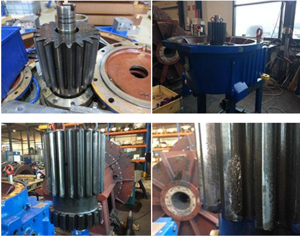
Εικόνα 4.3.12: Παράδειγμα φθοράς σε οδοντωτό τροχό του κιβωτίου
