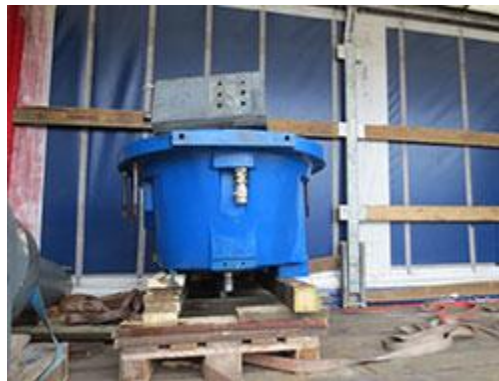
Εικόνα 4.3.9 : Αποσυναρμολόγηση του κιβωτίου ταχυτήτων
