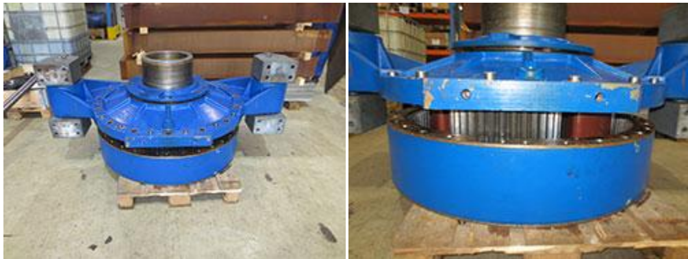
Εικόνα 4.3.11: Αποσυναρμολόγηση του πλανητικού
