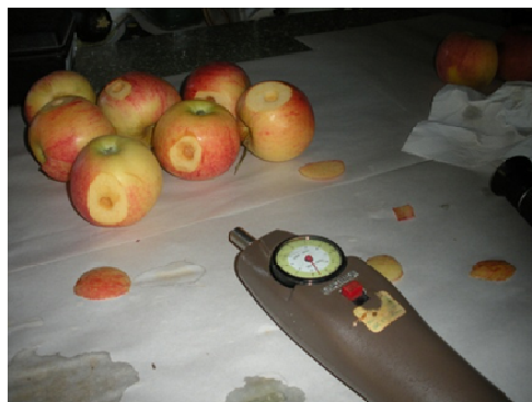
Εικόνα 12. Δυναμόμετρο και διαδικασία μέτρησης συνεκτικότητας σάρκας
