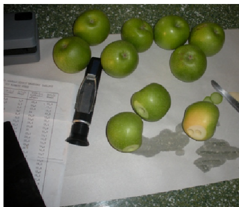
Εικόνα 13. Οπτικό διαθλασίμετρο και διαδικασία μέτρησης σακχάρων
