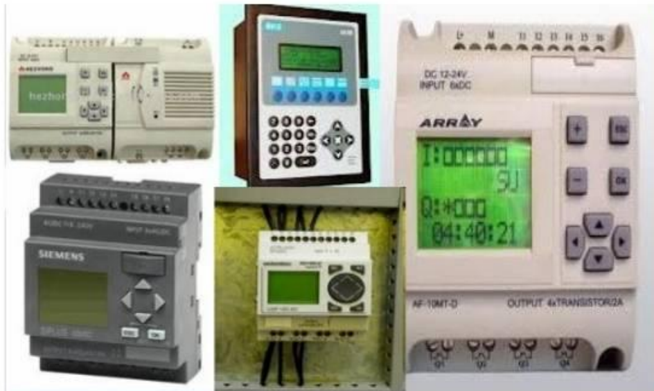
Εικόνα 23. PLC διαφόρων μηχανημάτων
