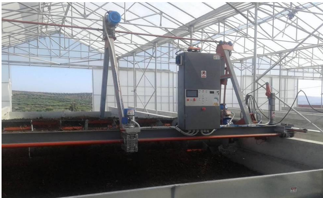
Εικόνα 18. Το μηχάνημα ηλιακής ξήρανσης με τους αυτοματισμούς του, εντός της μονάδας ξήρανσης
