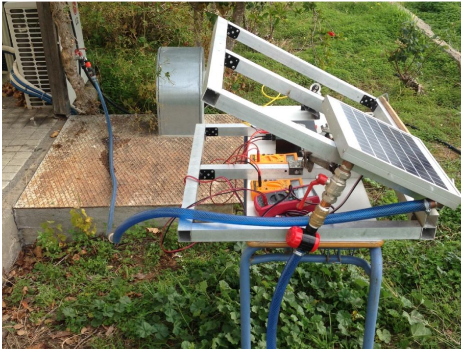
Εικόνα 34: Πειραματική διάταξη συστήματος ψύξης.
