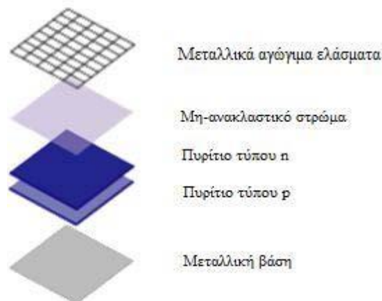
Εικόνα 02: Δομή ΦΒ στοιχείου.
