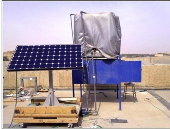
Εικόνα 08: Διάταξη ΦΒ πλαισίου συνδεδεμένο με δεξαμενή νερού
