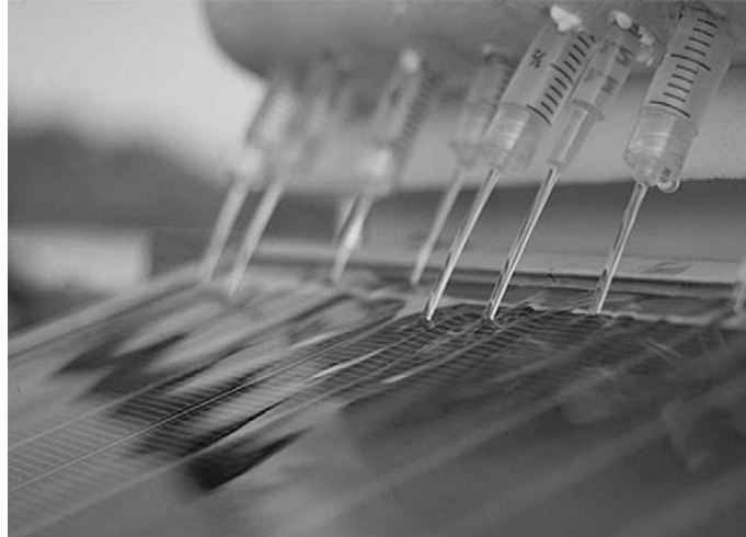
Εικόνα 13: Δημιουργία μιας λεπτής στρώσης νερού στην επιφάνεια του ΦΒ.
