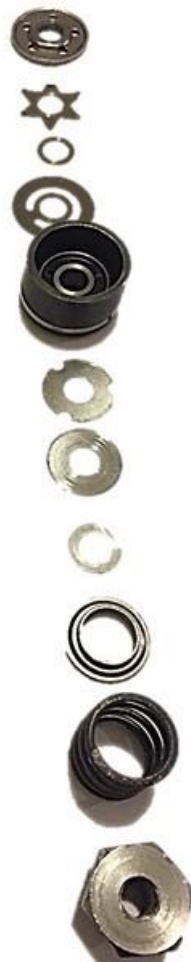
Εικόνα 40: Ολοκληρωμένη διάταξη εμβόλου αποσβεστήρα ταλαντώσεων κατασκευής.
