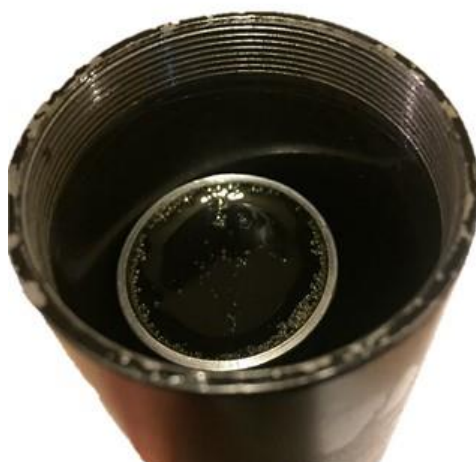
Εικόνα 52: Πλήρωση του εσωτερικού σωλήνα με υδραυλικό λάδι.
