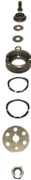
Εικόνα 42: Διάταξη βαλβίδας συμπίεσης - βάσης αποσβεστήρα ταλαντώσεων κατασκευής.
