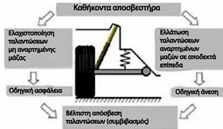
Εικόνα 21: Τα καθήκοντα του αποσβεστήρα ταλαντώσεων.
