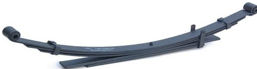
Εικόνα 20: Ξηρή μορφή απόσβεσης με ημιελλειπτικά ελατήρια (σούστες).
