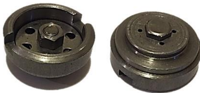
Εικόνα 51: Συναρμολογημένη βαλβίδα συμπίεσης - βάσης αποσβεστήρα ταλαντώσεων κατασκευής.
