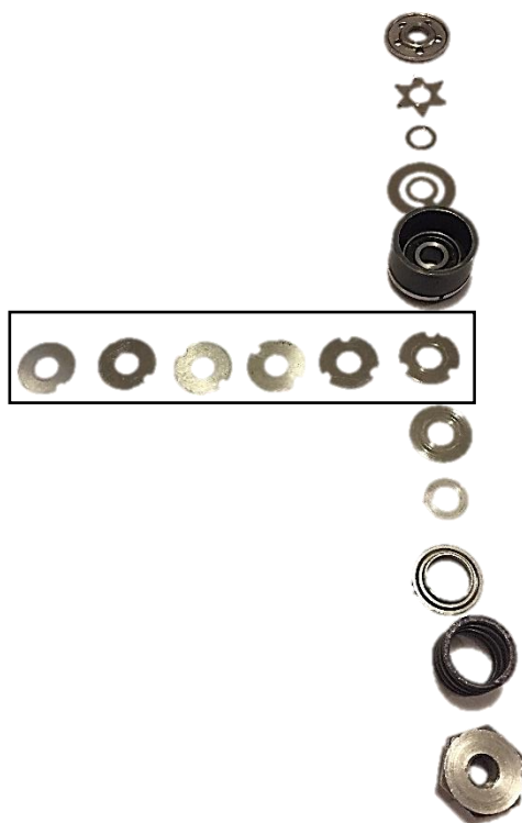
Εικόνα 57: Αποσυναρμολογημένη διάταξη εμβόλου και σύνολο εύκαμπτων ροδελών των έξι πειραμάτων (μέσα στο πλαίσιο).
