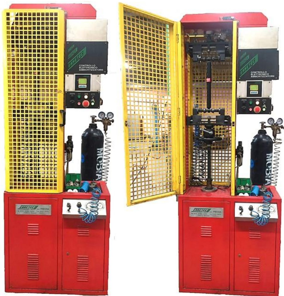
Εικόνα 56: Δυναμόμετρο αποσβέσεων αποσβεστήρων ταλαντώσεων Precisa της εταιρίας Emmetec.
