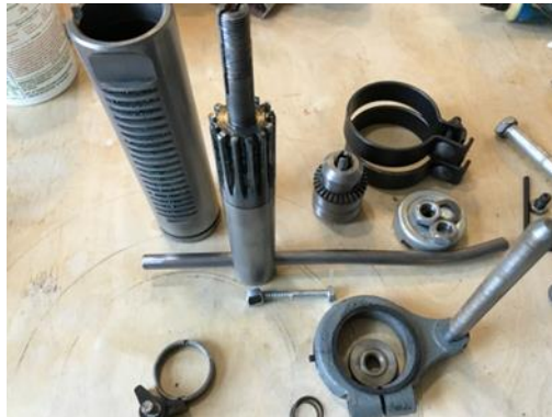
Εικόνα 8 Αποσυναρμολογημένη κεφαλή δράπανου Rockwell 15-081
