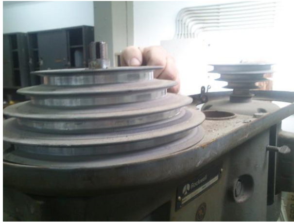
Εικόνα 21. Κιβώτιο ταχυτήτων ανοιχτό χωρίς τον ιμάντα.
