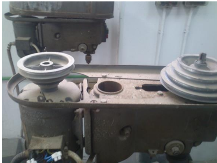
Εικόνα 19. Οι οξειδώσεις στο δράπανο και η μηχανή χωρίς ιμάντα.
