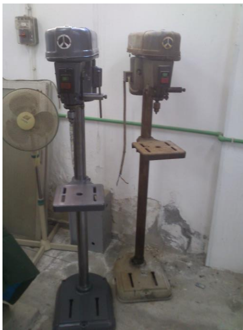
Εικόνα 51. Δράπανο ανακατασκευασμένο και αρχικό.
