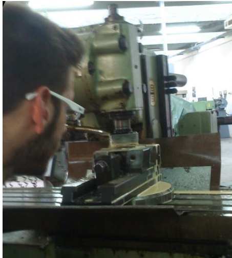
Εικόνα 44. Κατασκευή σφήνας στο εργαστήριο του μηχανουργείου.
