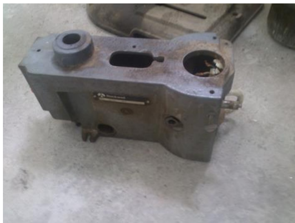
Εικόνα 35. Ο κορμός της μηχανής διάτρησης.
