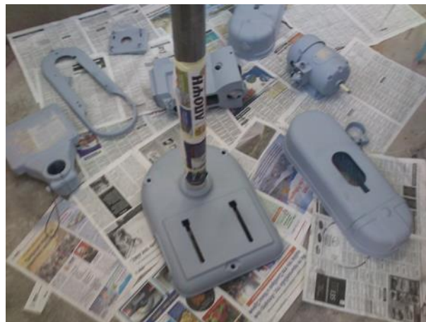
Εικόνα 41. Τεμάχια δραπάνου μετά το πέρας του υποστρώματος.
