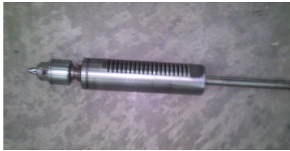
Εικόνα 47. Άτρακτος με το χιτώνιο της.
