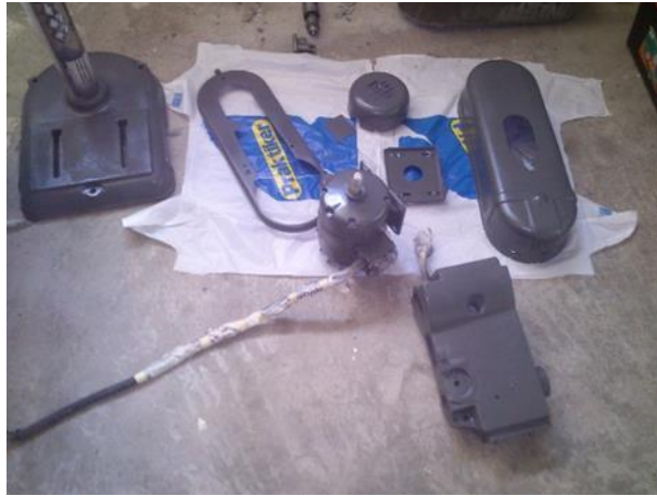
Εικόνα 42. Τεμάχια δραπάνου μετά την τελική βαφή.
