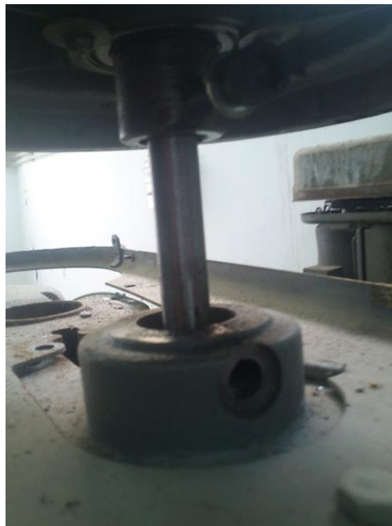
Εικόνα 24. Άξονας κίνησης τροχαλίας με τον κοχλία ασφαλείας.
