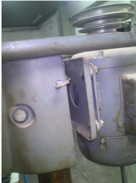
Εικόνα 34. Βάση στήριξης του κινητήρα.
