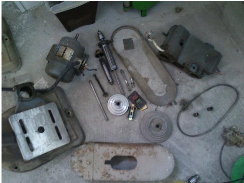
Εικόνα 38. Το δράπανο σε πλήρη αποσυναρμολόγηση.
