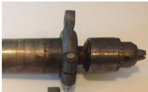
Εικόνα 29. Κεφαλή δράπανου κατά την αποσυναρμολόγηση.
