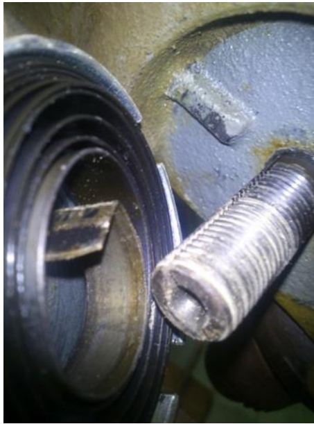
Εικόνα 28. Ελατήριο επαναφοράς του κυλίνδρου και μοχλού
