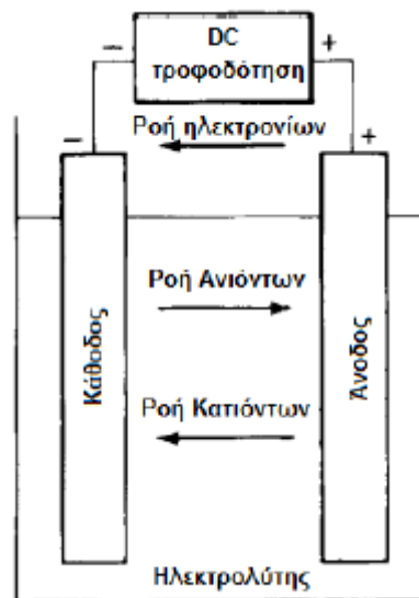
Εικόνα 7. Διαδικασία φόρτισης ενός επαναφορτιζόμενου στοιχείου.
