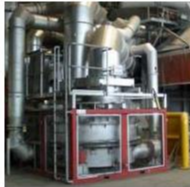
Εικόνα 4.1.7 : α) Σχηματική αναπαράσταση περιστροφικού ανανεωτήρα, πηγή : [PG&E, 1997] β) Περιστροφικός ανανεωτήρας που ανακτά ενέργεια από φούρνου τήξεως υλικών. [πηγή : Jasper GmbH, 2007]
