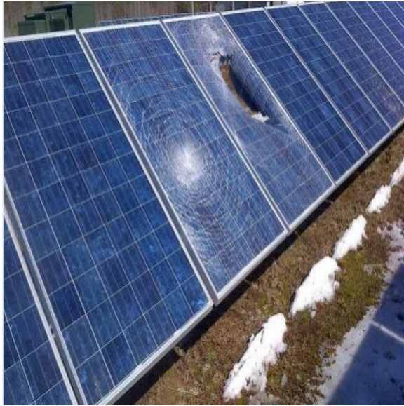
Εικόνα 36: Κατεστραμμένο πάνελ λόγω του χιονιού cxii
