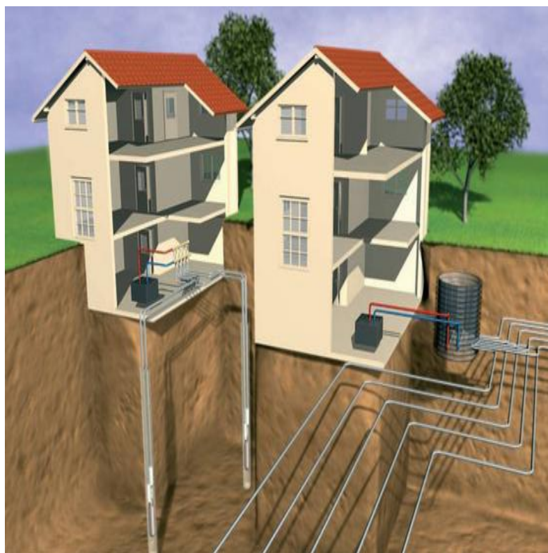
Εικόνα 24: Σχηματική διάταξη σε οικίες όπου χρησιμοποιούν γεωθερμική ενέργεια xcvi
