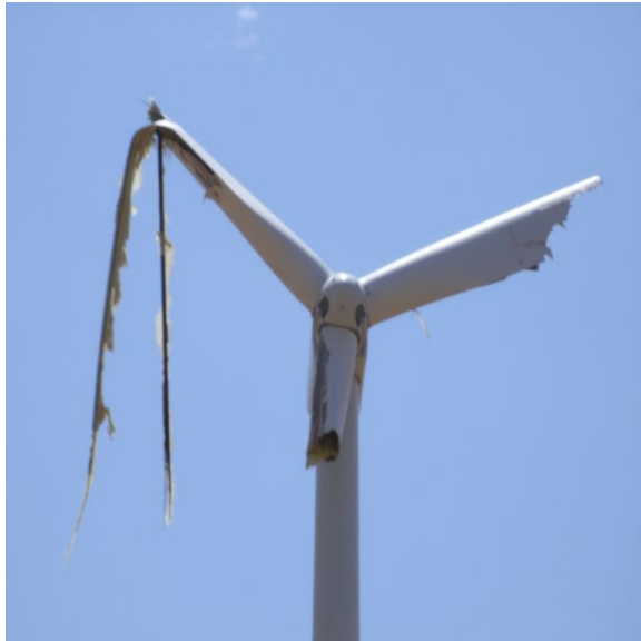
Εικόνα 35: Κατεστραμμένες έλικες λόγω ισχυρής χαλαζόπτωσης cxí
