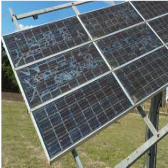
Εικόνα 34: Κατεστραμμένο πάνελ έπειτα από ισχυρή χαλαζόπτωση cx
