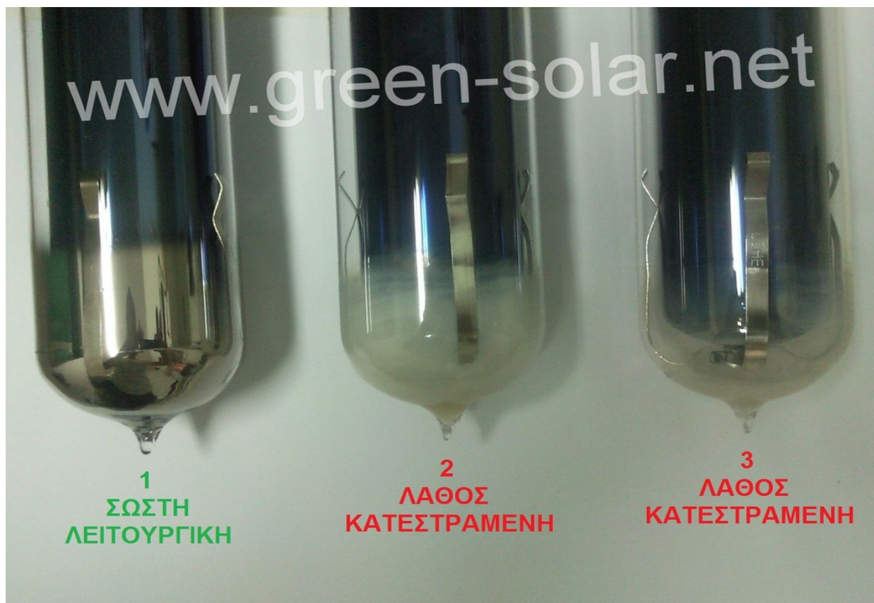
Εικόνα 55: Υαλοσωλήνες με σωστή και λάθος λειτουργία cxvii
