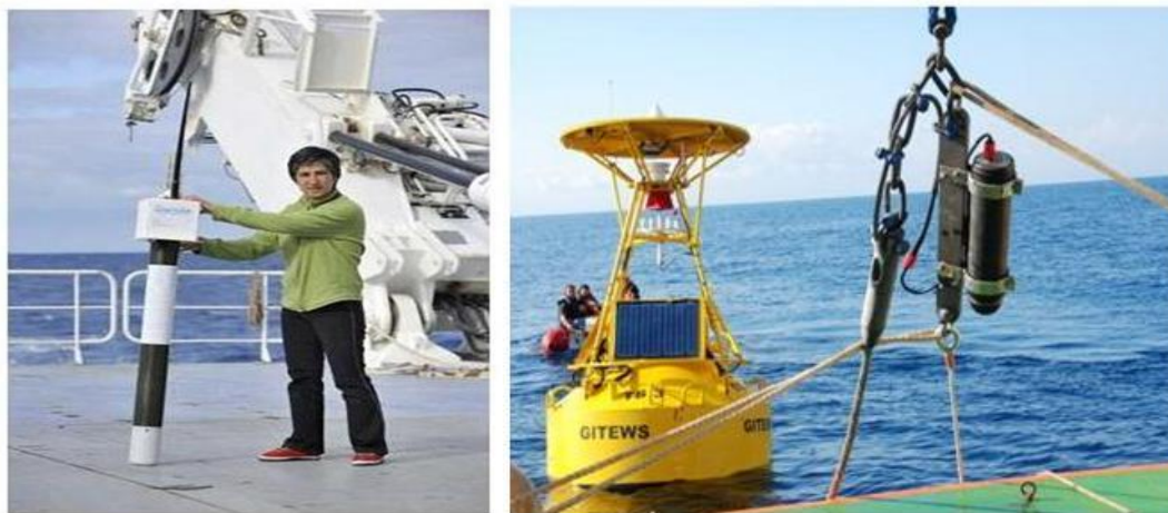
Εικόνα 1-2: Παράδειγμα αυτόνομου (Argo) και αγκυροβολημένου ωκεανογραφικού οργάνου
