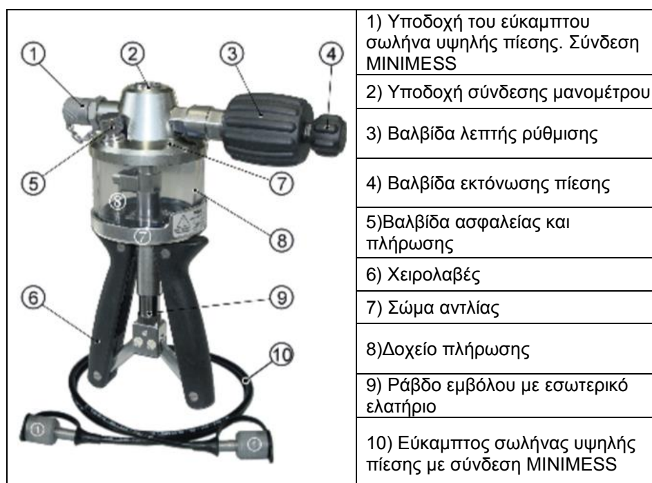
Εικόνα 4-23: Υδραυλική χειροκίνητη αντλία ΗΤΡΠ
