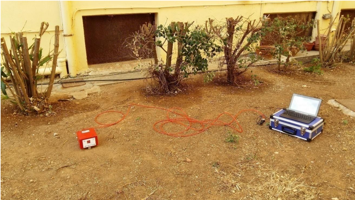
Σχήμα 3.9. Καταγραφή, ψηφιοποίηση και αποθήκευση δεδομένων καταγραφής εδαφικού θορύβου.
