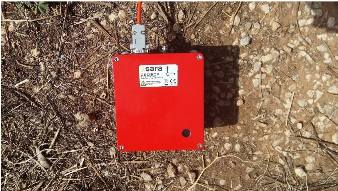
Σχήμα 3.8. Αισθητήρας καταγραφής εδαφικού θορύβου της GEOBOX ( http://www.sara.pg.it/index.php/221-sr04-geobox-digital-sensor/?lang=en )
