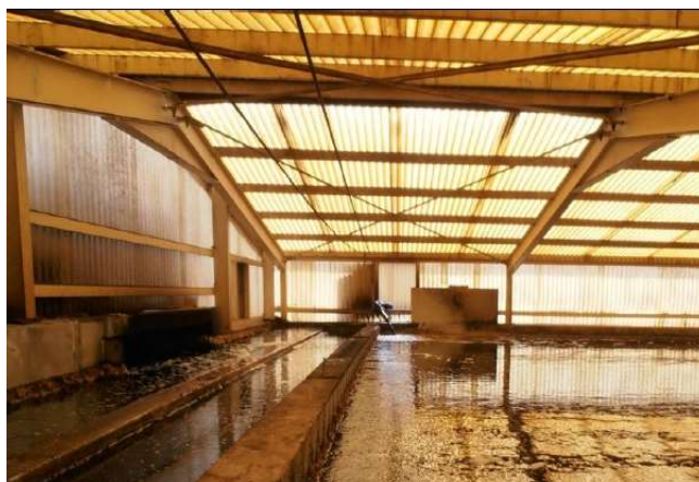
Σχήμα 4.12: Τμήμα αναμικτήρα (Υπηρεσία Μεταλλείων του Υπουργείου Γεωργίας)
