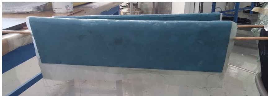
Εικόνα 3-8 : Τοποθέτηση εμποτισμένου πανιού με ρηίνη.
