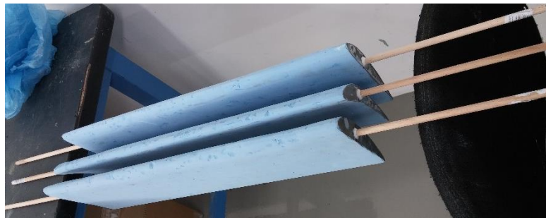
Εικόνα 3-5 : Τοποθέτηση ράβδου 8mm σε κάθε αεροτομή.
