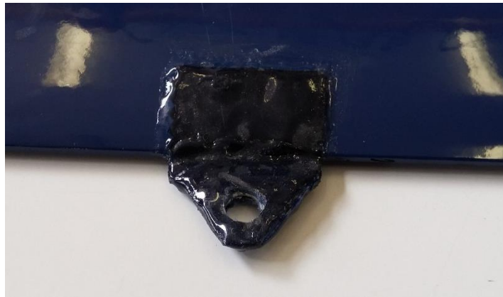
Εικόνα 3-24 : Τοποθέτηση πανιού, DP100 και μετάλλου.
