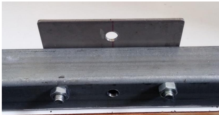
Εικόνα 3-19 : Τοποθέτηση ανοξείδωτης μεταλικής πλάκας στην δοκό.
