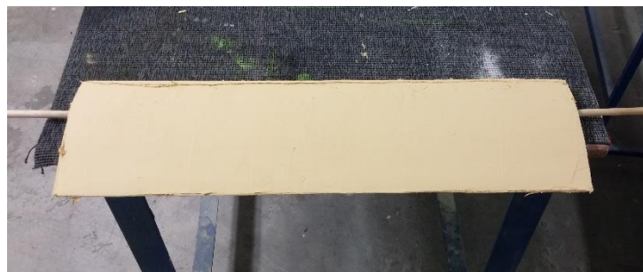
Εικόνα 3-12 : Τοποθέτηση Polystop LP πάνω στις αεροτομές.
