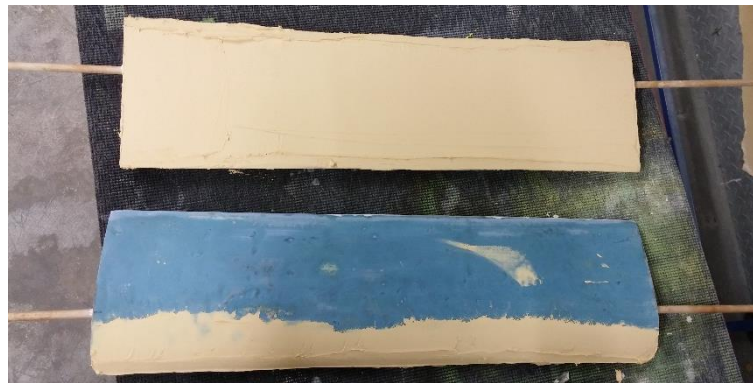
Εικόνα 3-11 : Τοποθέτηση Polystop LP πάνω στις αεροτομές.
