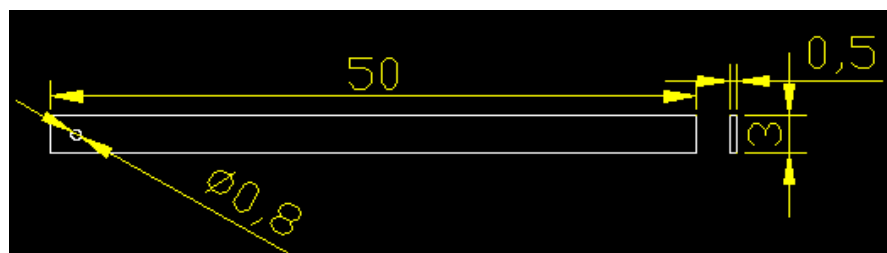
Εικόνα 3-16 : Λάμα (x2) (οι διαστάσεις είναι σε cm εκτός της τρύπας που είναι σε mm).
