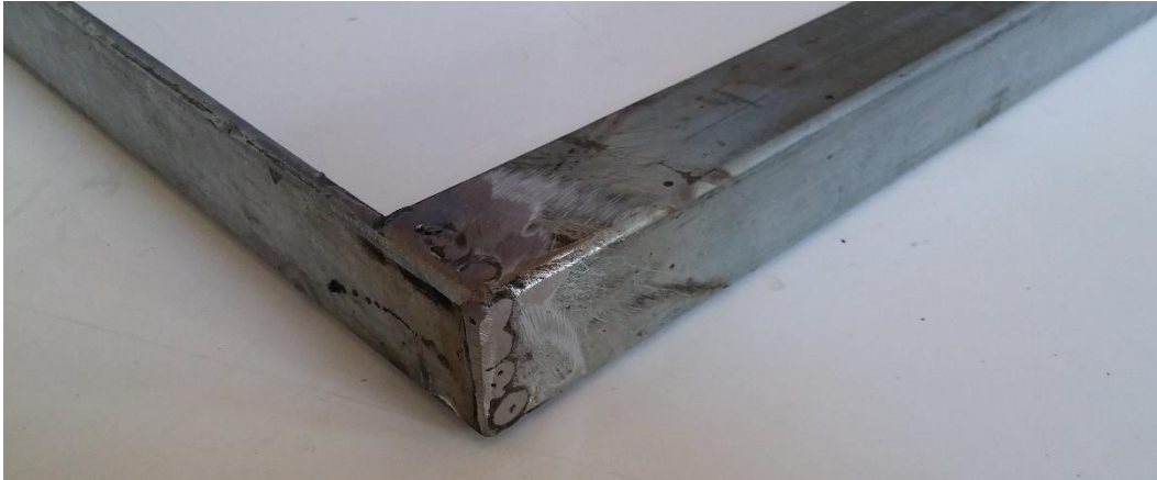
Εικόνα 3-17 : Ηλεκτροκόλληση δοκού με λάμες.
