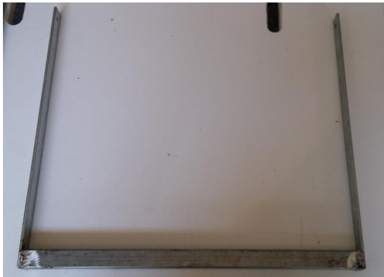
Εικόνα 3-18 : Δημιουργία «Π» με δοκό και λάμες.
