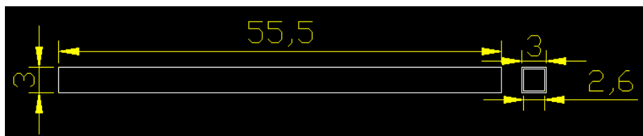
Εικόνα 3-15 : Δοκός (x1). (οι διαστάσεις είναι σε cm).
