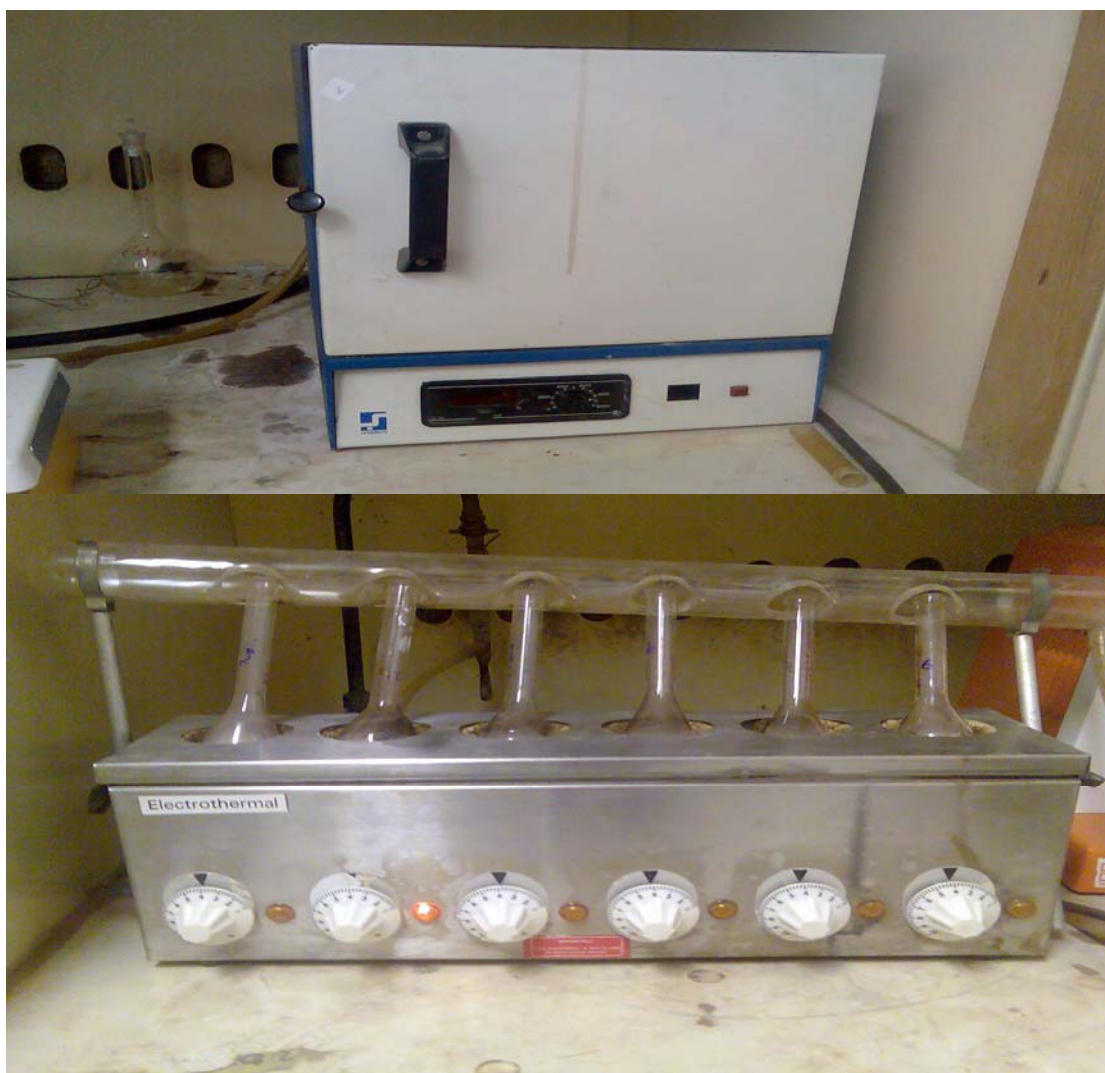
Εικόνα 2.3: Εστία πέψης mikrokjeldahl-electrothermal με φιάλες πέψης των 30 ml. Και Φούρνος καύσης υψηλών θερμοκρασιών: Snijders Scientific .
