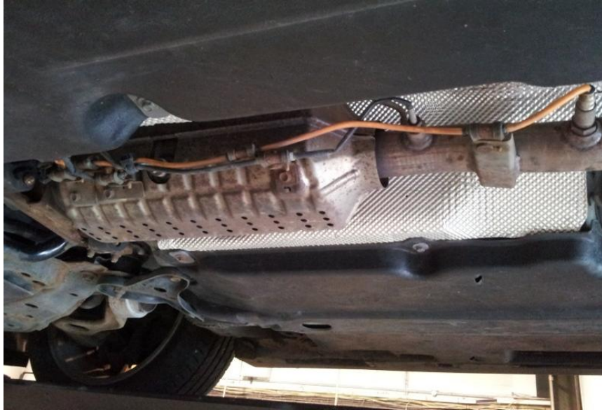
Εικόνα 5.21. Εξωτερική όψη φίλτρου σωματιδίων, το οποίο είναι συνδεδεμένο στο σύστημα εξαγωγής του αυτοκινήτου.
