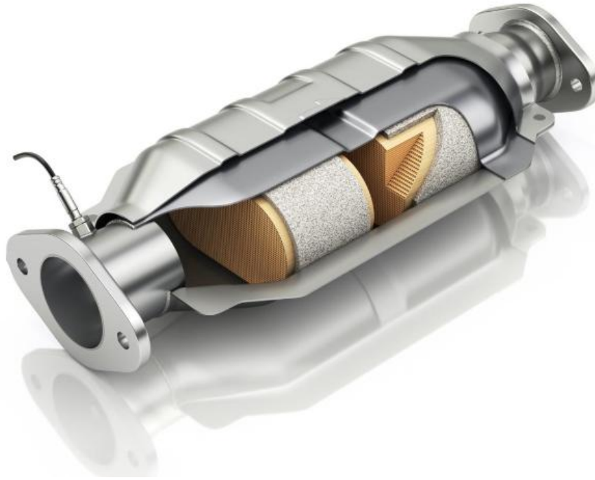
Εικόνα 5.2. Τριοδικός καταλύτης και η εσωτερική του δομή (motor.ONEHOWTO, 2018).
