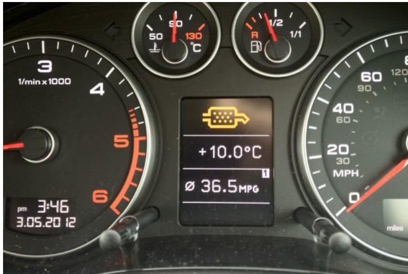
Εικόνα 5.23. Εμφάνιση λυχνίας στον πίνακα οργάνων, σχετικά για την προειδοποίηση της επείγων αναζωογόνησης φίλτρου σωματιδίων από τον οδηγό (GARAGEWIRE, 2015).
