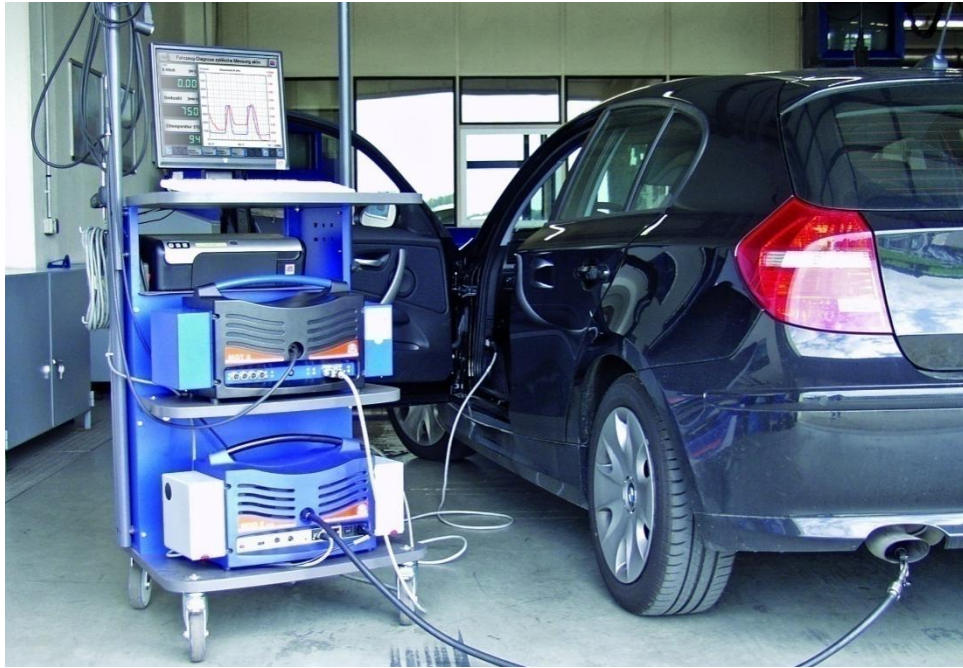
Εικόνα 7.1. Αναλυτής καυσαερίων MGT 5 (MAHA IRELAND).
