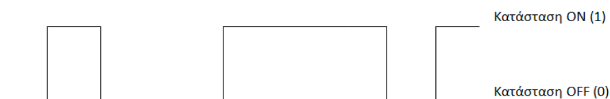
Εικόνα 5.17. Ψηφιακός παλμός PWM και καταστάσεις ON και OFF.
