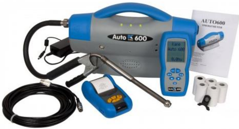
Εικόνα 7.2. Φορητό αιθαλόμετρο-νεφελόμετρο (KANE, Auto 600).
