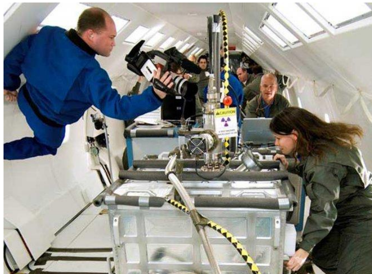
Εικόνα 62: Η παρουσίαση του πρωτότυπου 3D μεταλλικού εκτυπωτή τεχνολογίας EBF από τη NASA στον Διεθνή Διαστημικό Σταθμό
