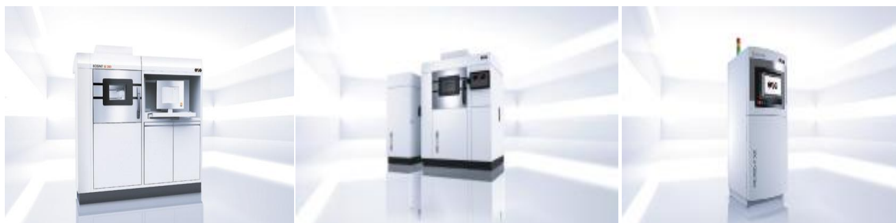
Εικόνα 45: Αριστερά ο EOSINT M 280, στη μέση ο EOS M 290 και δεξιά ο PRECIOUS M 080
