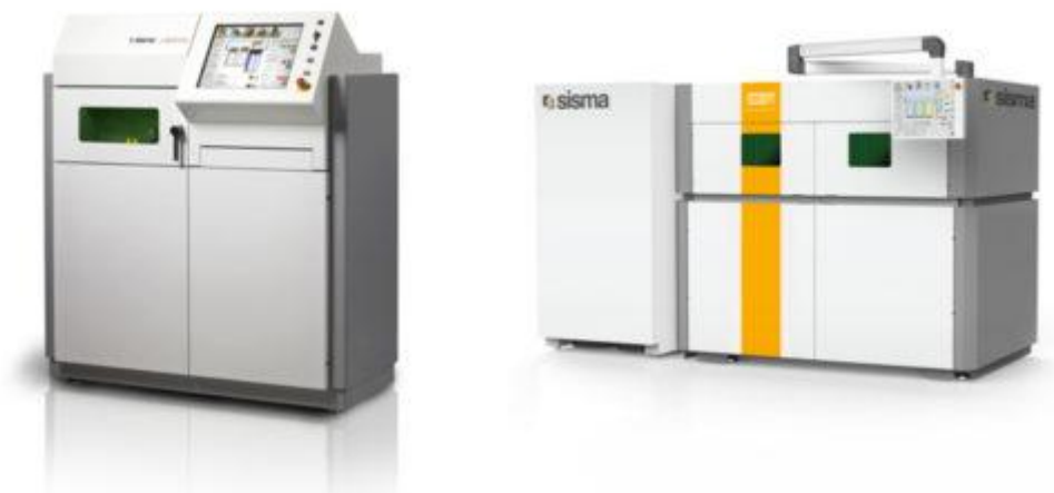
Εικόνα 67: Αριστερά ο MYSINT 100 και δεξιά ο MYSINT 300 3D μεταλλικός εκτυπωτής
