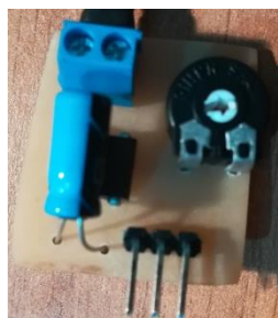
Εικόνα 12 : Ενδιάμεσο Κύκλωμα CT
