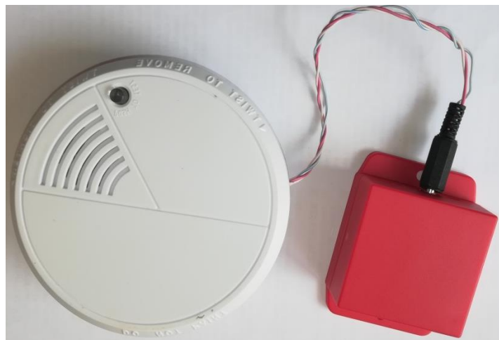
Εικόνα 56: Αισθητήρας Καπνού & Προσαρμοστικό Κύκλωμα II
