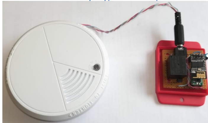
Εικόνα 55: Αισθητήρας Καπνού & Προσαρμοστικό Κύκλωμα I
