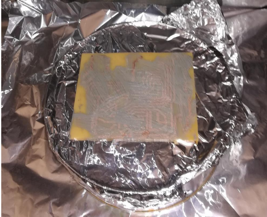
Εικόνα 47: Επικασσιτέρωση με ROSOL 3 στους 230 °C
