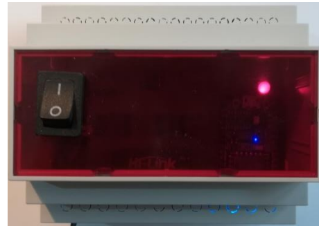
Εικόνα 51: ESP-12 σε Κουτί για Ηλ. Πίνακα
