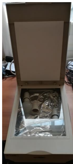
Εικόνα 44 : Θάλαμος Έκθεσης UV ακτινοβολίας
