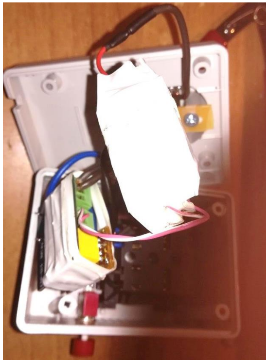
Εικόνα 48: Αυτόνομος Ηλεκτρονόμος – Πρίζα Εσωτερικό
