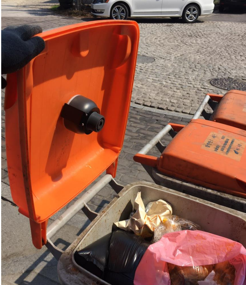
Εικόνα 5.8: Έξυπνος αισθητήρας στάθμης τοποθετημένος σε τοπικό κάδο απορριμμάτων
