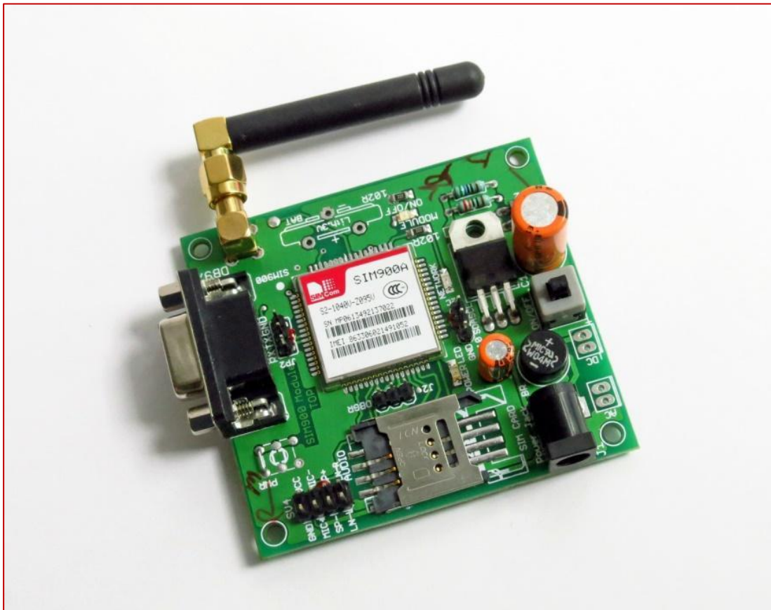
Εικόνα 5.9: Ηλεκτρονικός αναμεταδότης δεδομένων με χρήση κινητού δικτύου GSM
