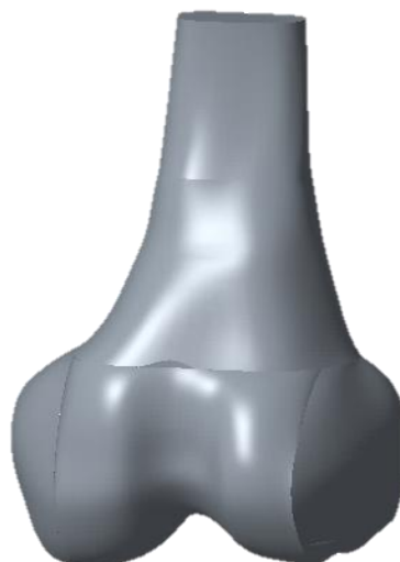
Εικόνα 7.12 Μοντελοποίηση Μηρού με την εντολή Sweep και Swept Blend
