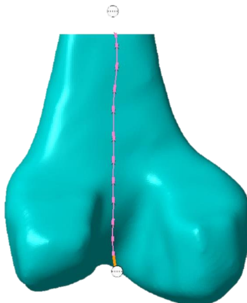
Εικόνα 7.17 Δημιουργία πρώτης καμπύλης με επιλογή σημείων
