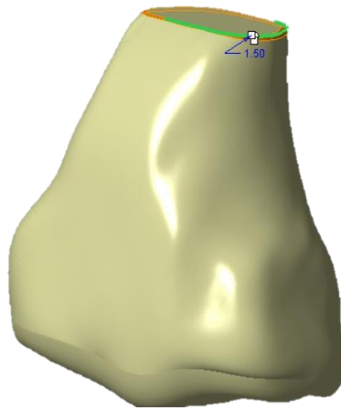
Εικόνα 7.41 Τροποποίηση της ακμής με την εντολή Round
