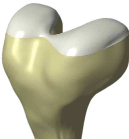
Εικόνα 7.24 Στερεοποίηση πρώτου πλαϊνού με την εντολή Solidify
