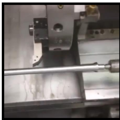
Εικόνα 179: Απεικόνιση ξεχωνδρίσματος κάνης στον CNC τόρνο SL 20.
