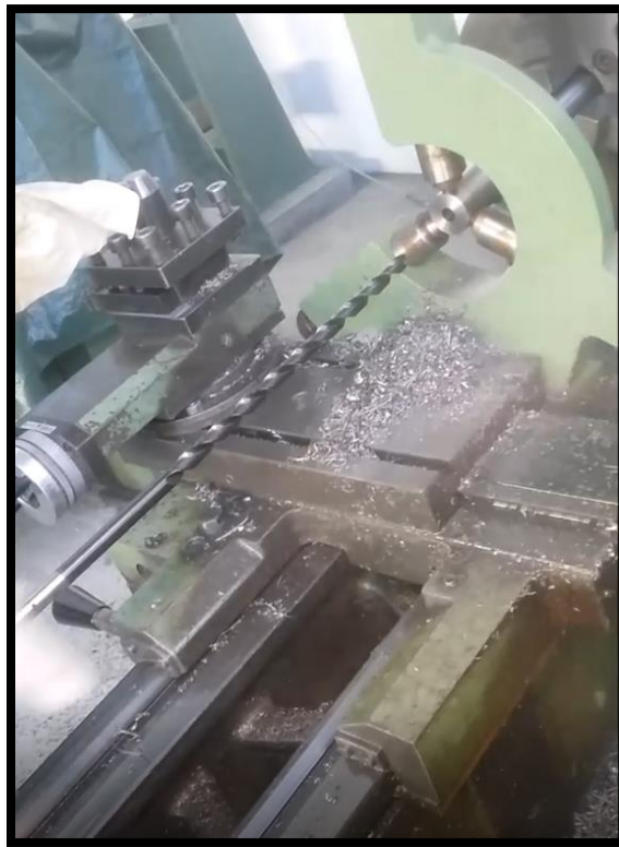
Εικόνα 178: Απεικόνιση της διαδικασίας τρυπήματος στον συμβατικό τόρνο.
