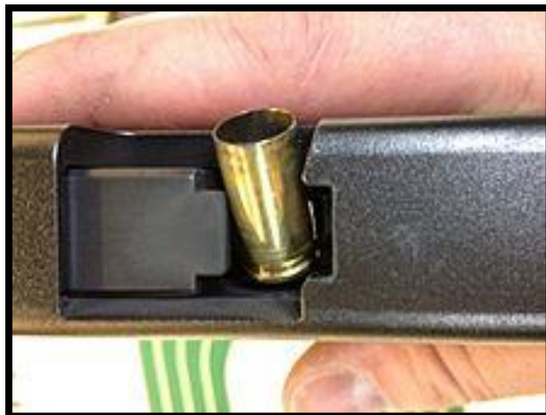
Εικόνα 13: Ενδεικτική εμπλοκή σε πιστόλι
