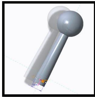
Εικόνα 149: Απεικόνιση εξοχής για την σφήνωση στην οπή του κλείστρου.
