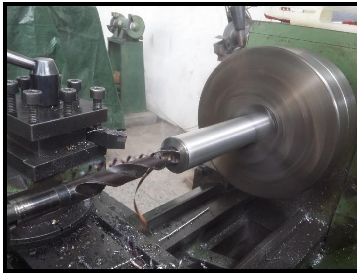
Εικόνα 169: Απεικόνιση κατεργασίας μπροστινού μέρους main receiver.
