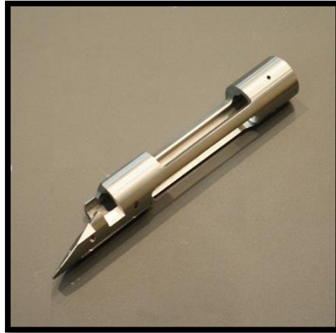
Εικόνα 18: Μάνα κλείστρου από πολυχρωμιούχο χάλυβα
