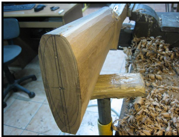
Εικόνα 160: Κοντάκι υπό κατασκευή στο χέρι.
