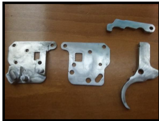
Εικόνα 174: Απεικόνιση αριστερής πλάκας της σκανδάλης μετά την κατεργασία και πριν την διαδικασία λείανσης.
