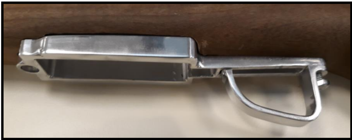
Εικόνα 159: Magazine guard και trigger guard από αλουμίνιο 7075.
