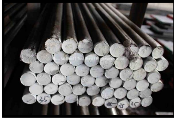
Εικόνα 155: Ράβδοι ακατέργαστου πολυχρωμιούχου χάλυβα στέψεως 300 Brinell.
