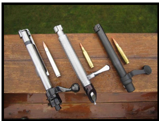
Εικόνα 17: Τρία είδη κλείστρων κινητού ουραίου για διαφορετικούς τύπους διαμετρημάτων φυσίγγιου.
