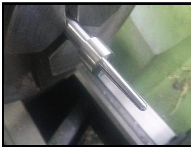
Εικόνα 187: Απεικόνιση εμπρόσθιου μέρους της βελόνας κατά την διάρκεια κατεργασίας στον τόρνο.
