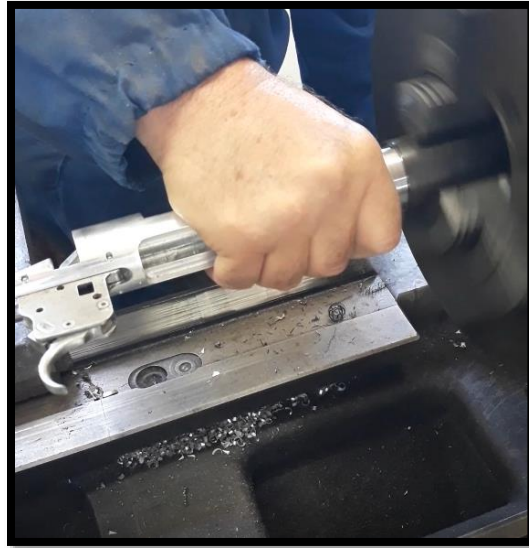
Εικόνα 196: Απεικόνιση ελέγχου αν οι διαστάσεις εξωτερικού σπειρώματος είναι εντάξει βιδώνοντας το main receiver επάνω.
