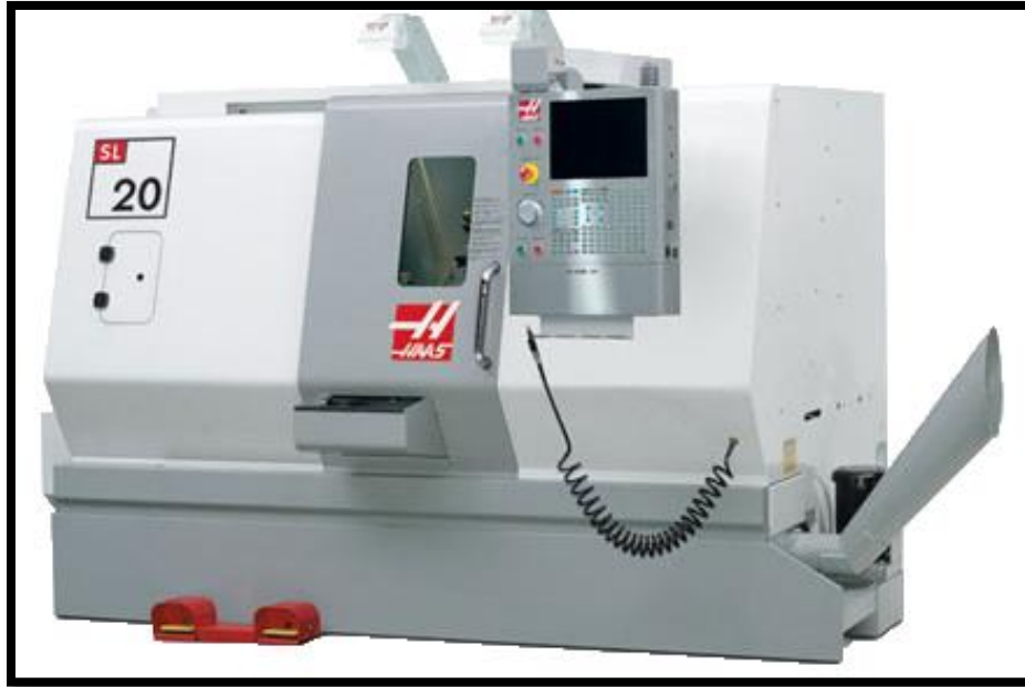
Εικόνα 162: CNC Τόρνος μοντέλο SL 20 LONG BED 2 αξόνων.
