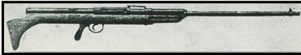
Εικόνα 7: Ημιαυτόματο τυφέκιο κατασκευαστή Ferdinand Ritter von Mannlicher 1885 μ.Χ.
