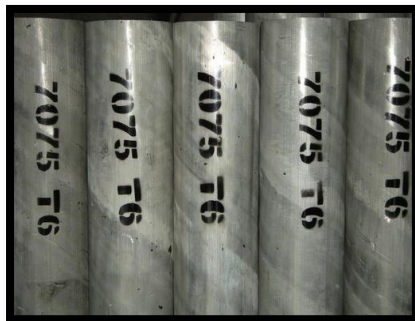
Εικόνα 156: Ράβδοι αλουμινίου με το όνομα του υλικού επάνω.
