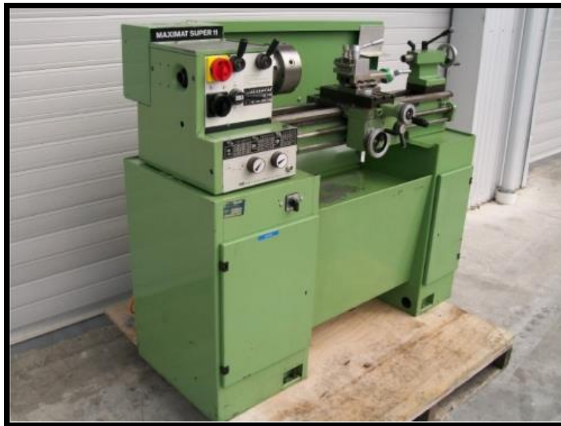
Εικόνα 165: Συμβατικός τόρνος μοντέλο EMCO 2.0.
