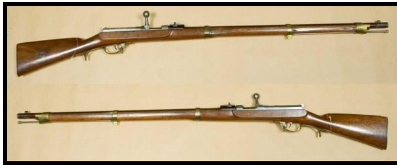
Εικόνα 8: Το Dreyse Needle gun του Johann Nikolaus πρώτο τουφέκι κινητού ουραίου παγκοσμίως.
