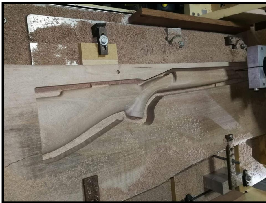
Εικόνα 168: Απεικόνιση κοντακιού που έχει πάρει μορφή η μία του πλευρά στο CNC Router του συμφοιτητή Παπαδόπουλου Γιώργου.
