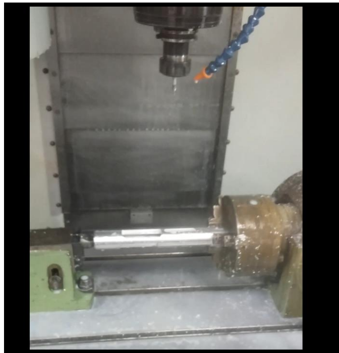
Εικόνα 171: Απεικόνιση του main receiver μετά την πρώτη κατεργασία στον διαιρέτη 360 μοιρών.
