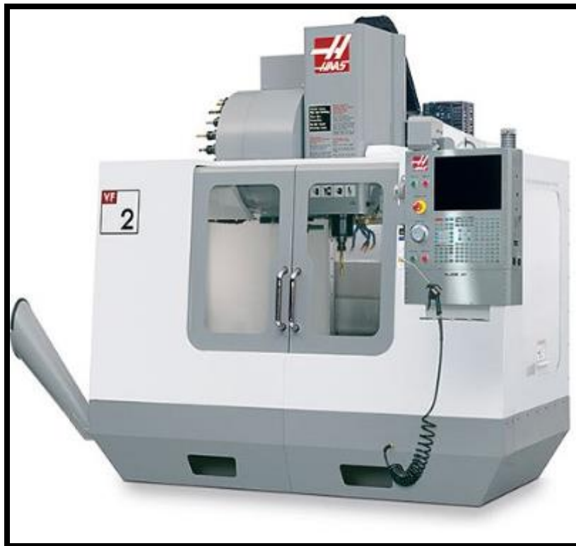
Εικόνα 163: CNC Φρέζα μοντέλο VF2 τεσσάρων αξόνων.
