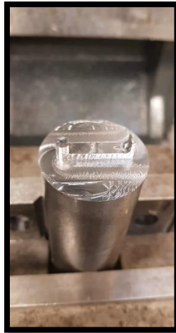
Εικόνα 192: Απεικόνιση εξωλκέα στην πρώτη φάση κατεργασίας.
