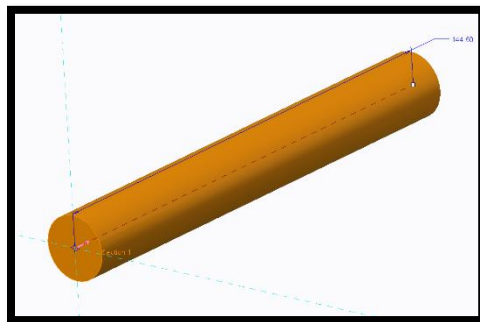
Εικόνα 102: Συμπαγής κύλινδρος για την δημιουργία του κορμού του κλείστρου.
