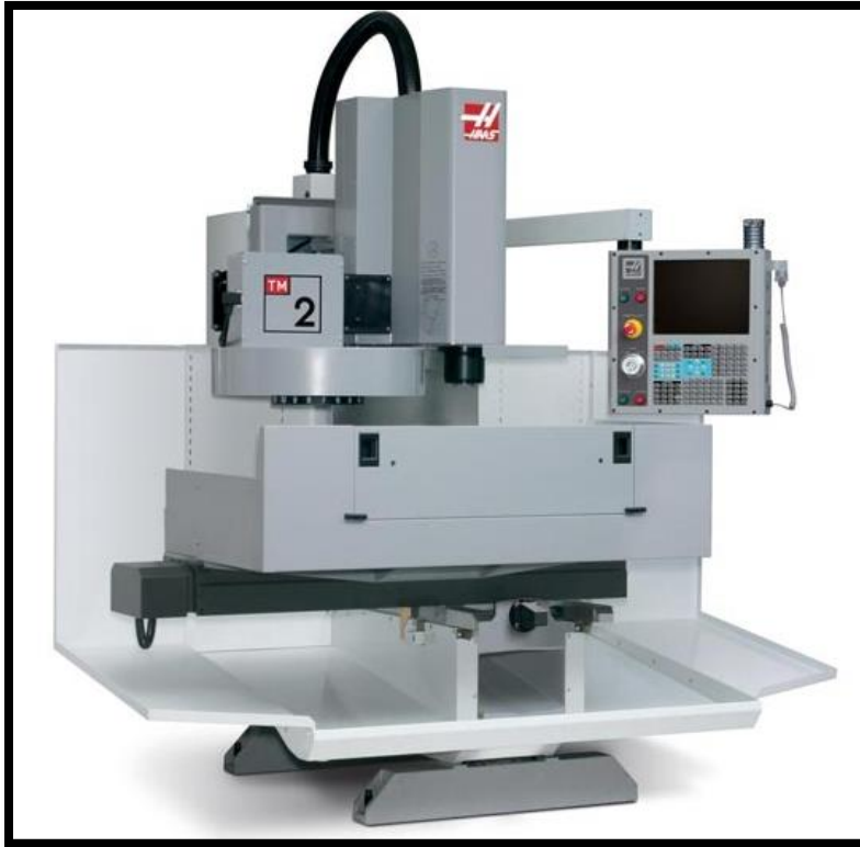
Εικόνα 164: CNC Φρέζα μοντέλο TM2 3 αξόνων.
