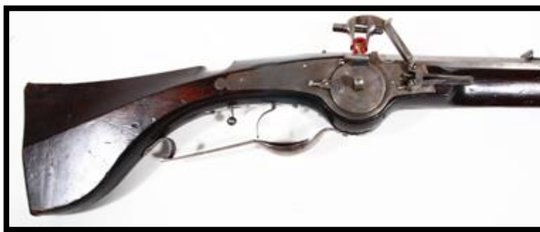
Εικόνα 2: Μουσκέτο τύπου Wheellock φαίνεται καθαρά ο τροχός και το μπράτσο που κρατά την πέτρα πυρίτη
