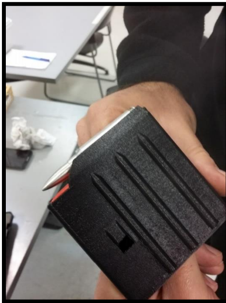
Εικόνα 181: Απεικόνιση εκτυπωμένου δοκίμιου από πολυγαλακτικό οξύ.
