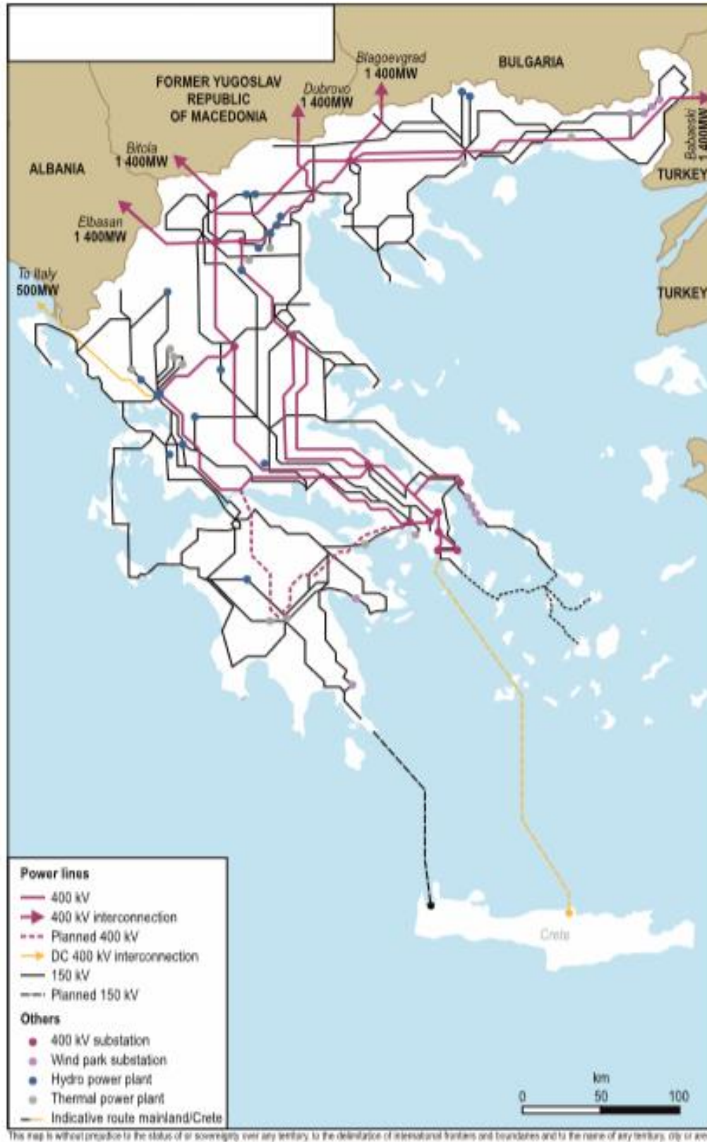
Σχήμα 10 Δίκτυο Ηλεκτρικής Ενέργειας [5]
