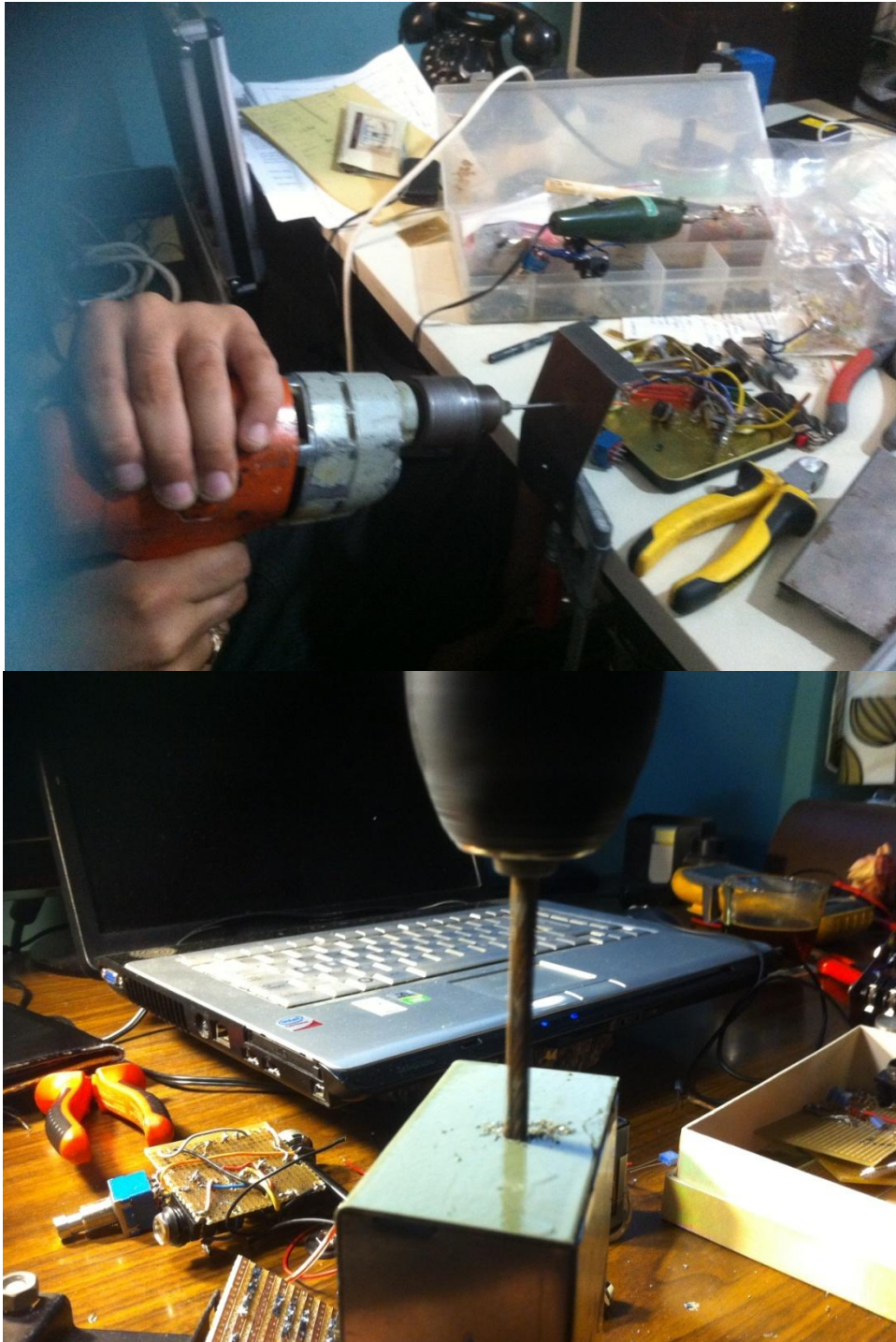
Εικόνα 5.2.15: Διάτρηση κουτιού με τρυπάνι για την τοποθέτηση των υλικών
