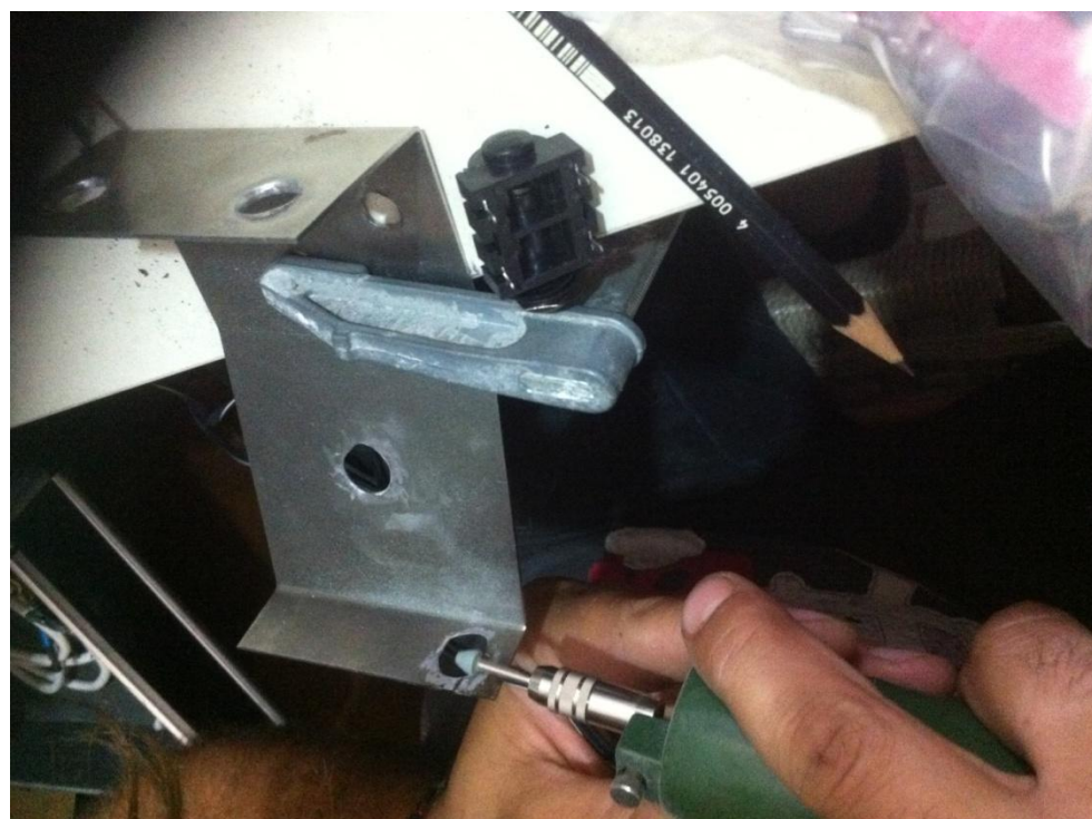
Εικόνα 5.2.19: Στάδιο τρύχισης εγκοπών
