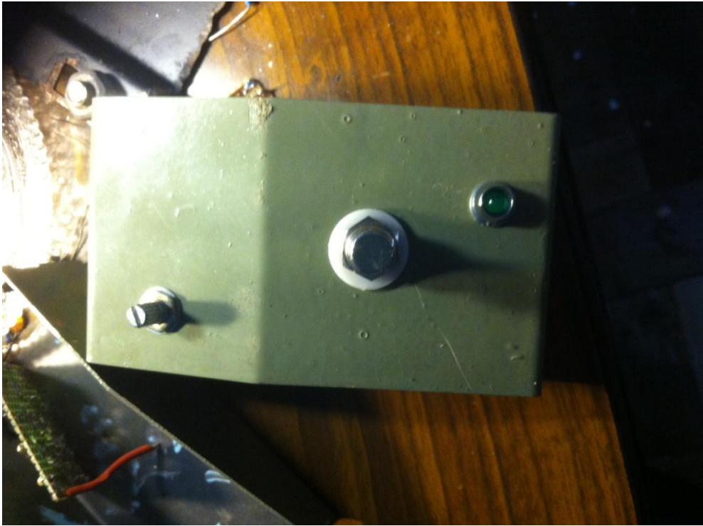
Εικόνα 5.2.20: Τοποθέτηση διακόπτη, ποτενσιομέτρου και led σε βαμμένο κουτί
