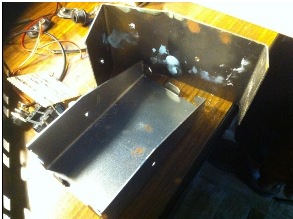
Εικόνα 5.2.17: Αρχικό στάδιο, τρύπες μικρής διαμέτρου στο κάτω μισό του κουτιού (θέσεις Jack)
