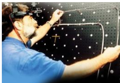
Εικόνα 3. Οι ερευνητές χρησιμοποιούν ένα HMD ώστε να καθοδηγήσουν τη συναρμολόγηση δεσμών καλωδίων για αεροσκάφη. [3]
