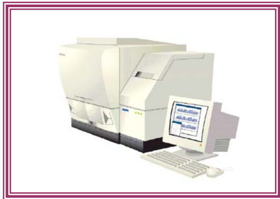
Εικ.17 Αυτόματο μηχάνημα sequence , όπου είναι δυνατό να αναλύση 450000 χιλιάδες βάσεις ανά ημέρα
