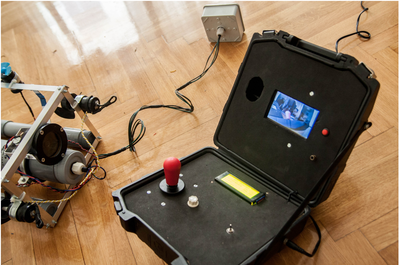
Δοκιμές μετάδοσης και προβολής εικόνας και τηλεμετρίας.
