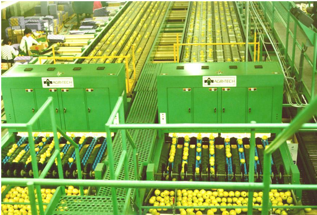
Εικόνα 1: Σύστημα γραμμικής ταξινόμησης φρούτων με βάση την «τεχνητή όραση»
