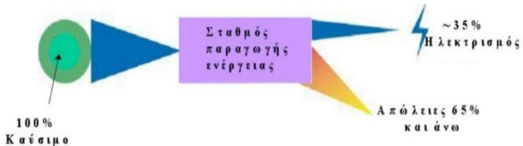
Σχήμα 4.24 Συμβατικό σύστημα παραγωγής ηλεκτρικής ενέργειας
