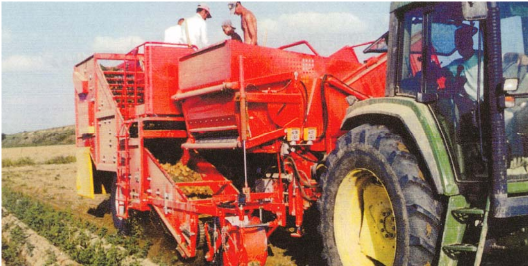
Συρόμενος Πατατοεξαγωγέας μιας σειράς φορτωτικός με διαλογητήριο
