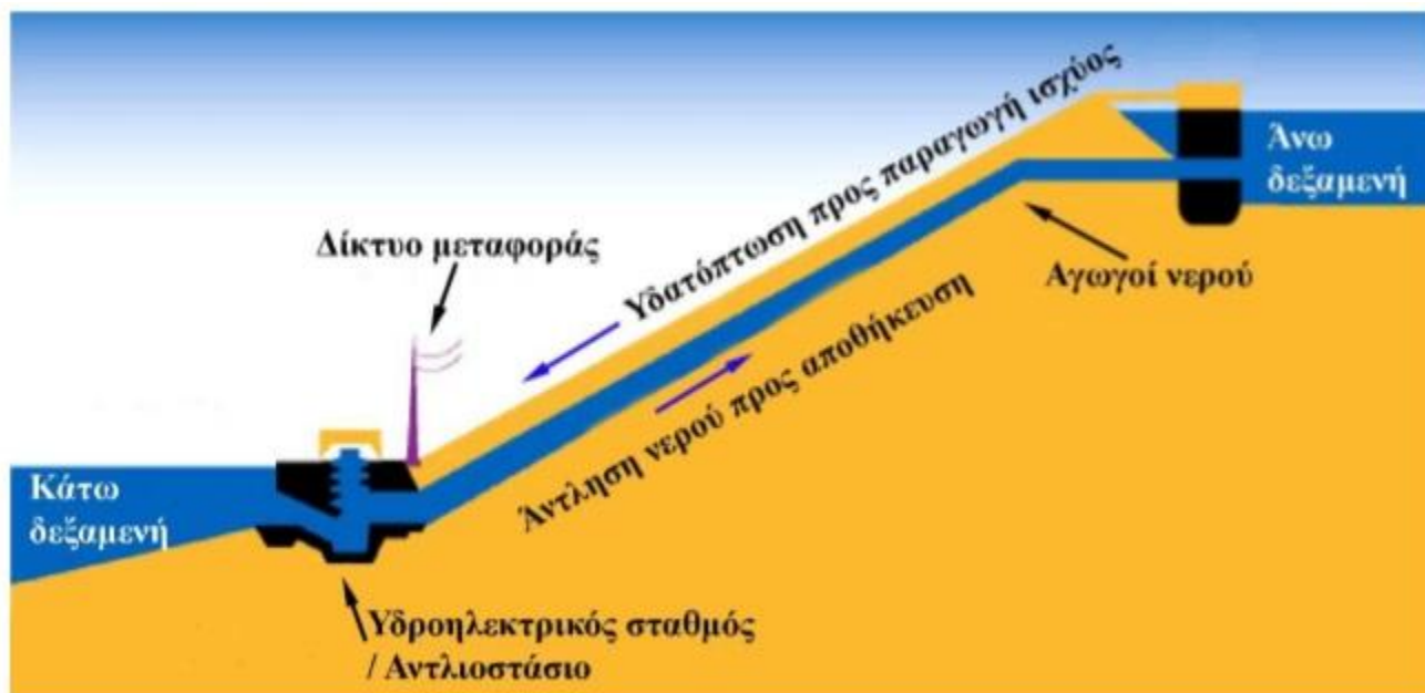
Εικόνα 3.2: Τρόπος λειτουργίας ενός αναστρέψιμου υδροηλεκτρικού
