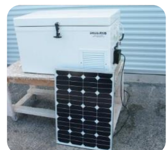
(Ηλιακό τροφοδοτικό για ψυγείο φαρμάκων)
