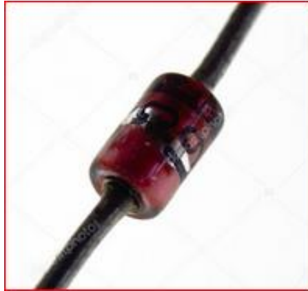
Εικόνα 81: Δίοδος πυριτίου (Si)
