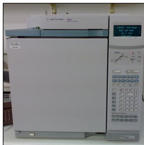
Εικόνα 11. Αέριος χρωματογράφος (Agilent 6890N, GC system)
