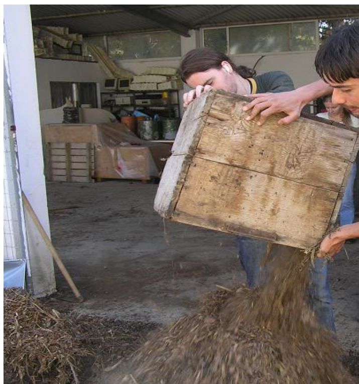
Εικόνα 23. Τοποθέτηση δεύτερου στρώματος κλαδοκάθαρων πάνω από τη λυμματολάσπη (σηματισμός σάντουιτς).
