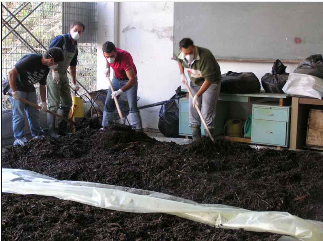
Εικόνα 31. Αναμόχλευση υλικού μετά το ψεκασμό.
