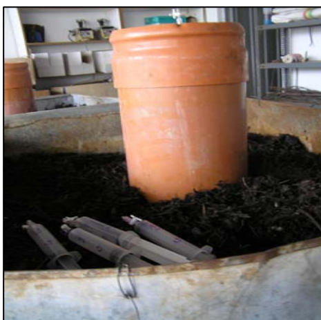
Εικόνα 10. Κυλινδρικά δοχεία για την λήψη των παραγόμενων αερίων
