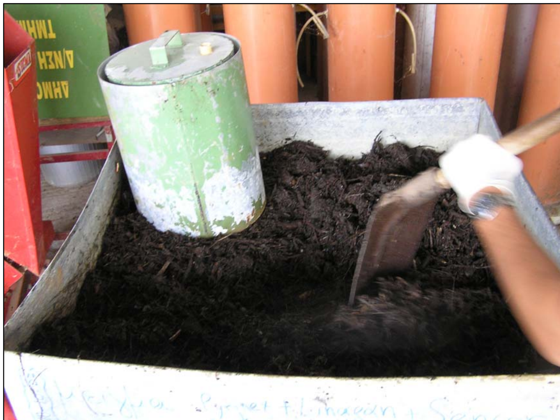
Εικόνα 34. Τοποθέτηση υλικών μέσα στα κιβώτια και κυλίνδρων για τη συγκέντρωση και μέτρηση των παραγόμενων αερίων.
