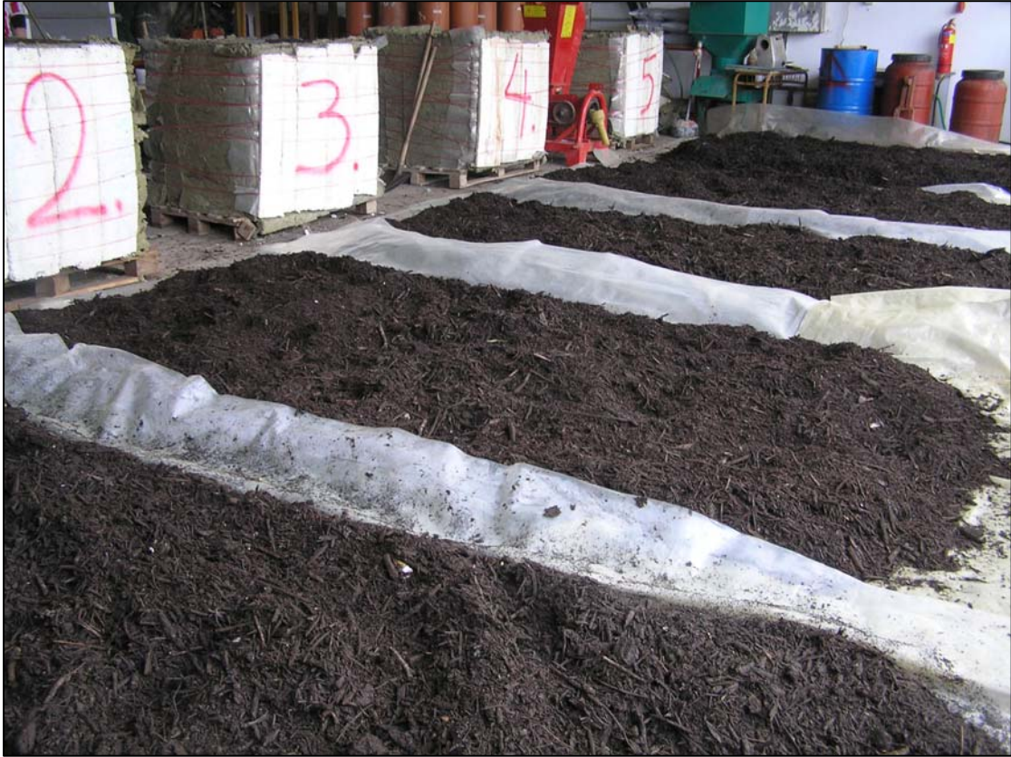
Εικόνα 33. Θερμομόνωση των κιβωτίων εξωτερικά με πλάκες πετροβάμβακα πάχους 5 cm και πλάκες διογκωμένης πολυστερίνης (φελιζόλ) πάχους 3 cm.
