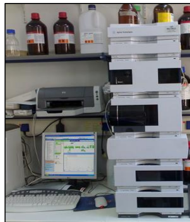
Εικόνα 13. Υγρός χρωματογράφος Agilent Technologies 1200 series
