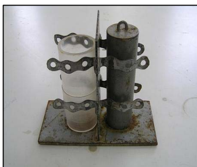
Εικόνα 5. Κύλινδροι και βαρίδιο για την συμπίεση του υλικού.
