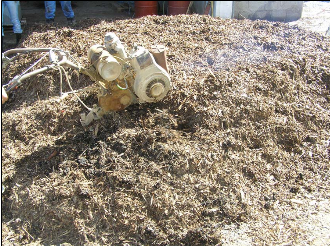
Εικόνα 24. Ανάμιξη κλαδοκαθάρων και λυματολάσπης με φρέζα.
