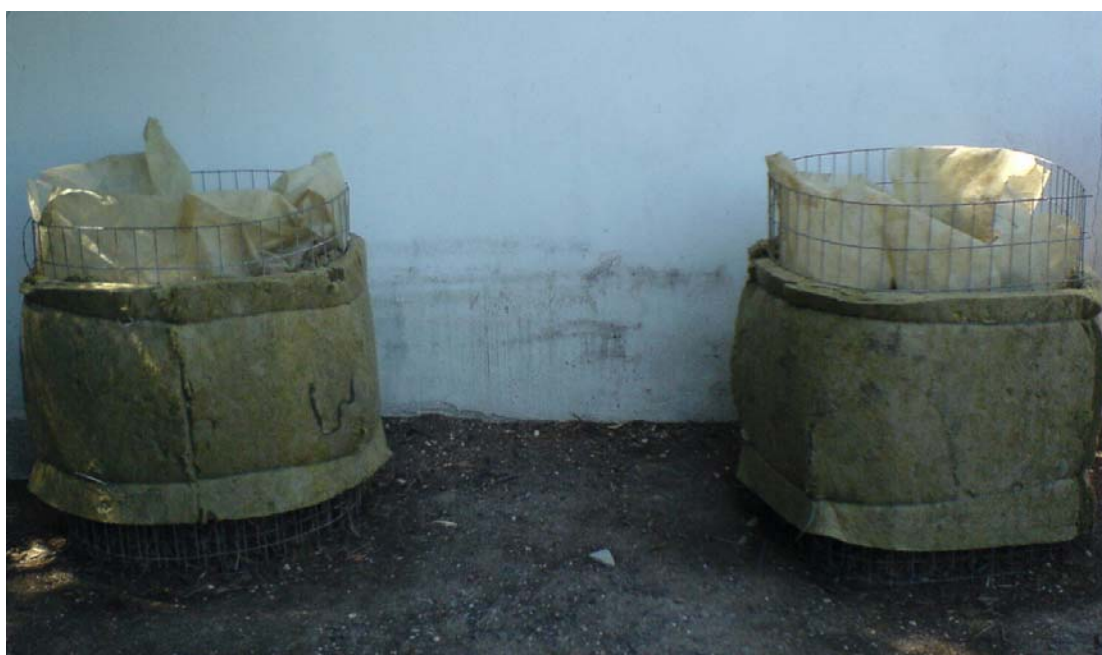
Εικόνα 2.12. Οι δυο σωροί κομποστοποίησης με την κανονική μόνωση από πετροβάμβακα για μείωση απωλειών υγρασίας και θερμοκρασίας.
