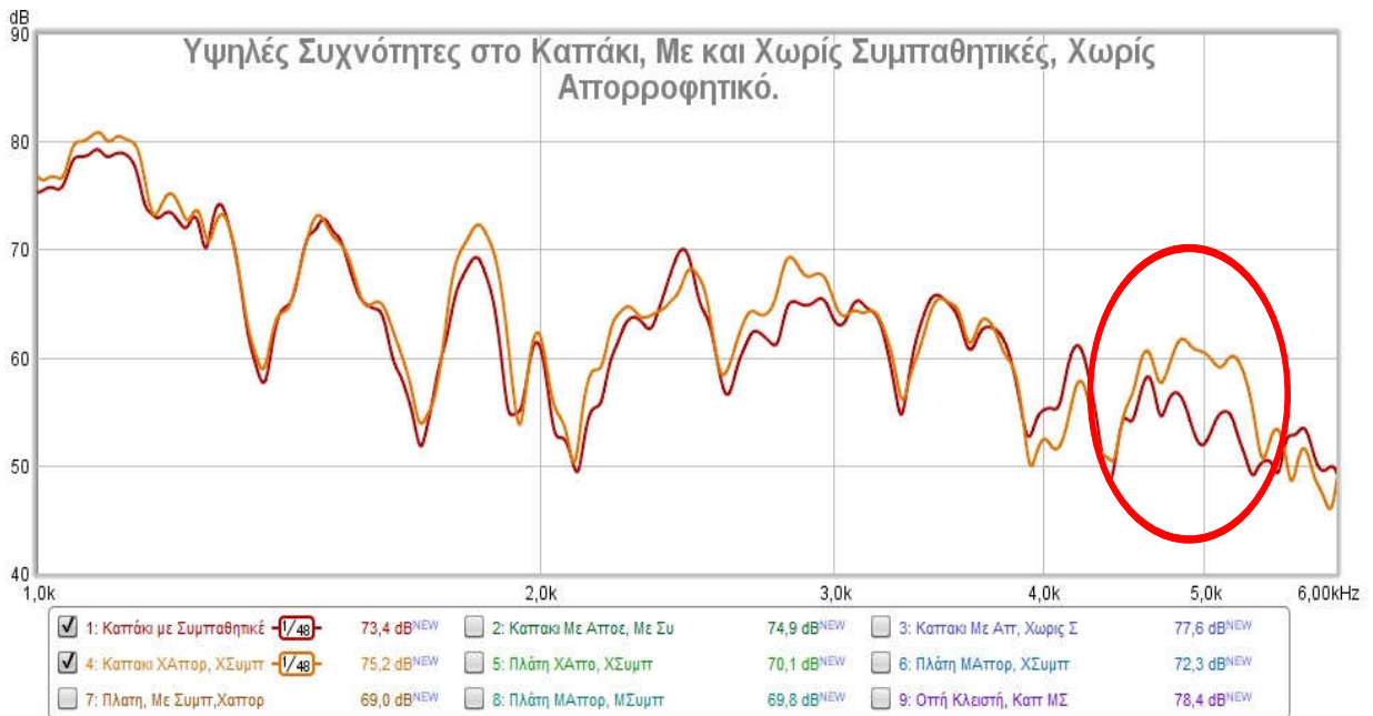
Εικόνα 30: Φάσμα υψηλών συχνοτήτων από τον ηχοβολισμό του οργάνου στο καπάκι της λύρας με ενεργές και ανενεργές τις συμπαθητικές χορδές, χωρίς απορροφητικό υλικό. Το κόκκινο χρώμα δείχνει το φάσμα με ενεργές τις συμπαθητικές χορδές, ενώ το κίτρινο, με ανενεργές τις συμπαθητικές χορδές. Δεν παρατηρούνται σημαντικές διαφορές πέραν του παραθύρου συχνοτήτων 4,5-5,5kHz, όπου εμφανίζονται ποιο «καθαροί» συντονισμοί στην απόκριση του καπακιού όταν οι συμπαθητικές χορδές είναι ενεργές αλλά με μικρότερο πλάτος.
