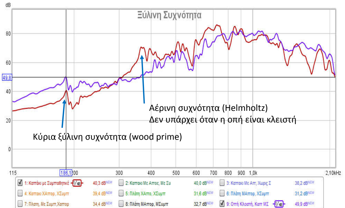
Εικόνα 38: Αέρια συχνότητα στα 366\text{Hz} όπως προκύπτει από τον ηχοβλοισμό του οργάνου στο καπάκι, με οπή κλειστή και ανοιχτή, με ενεργές τις συμπαθητικές χορδές, χωρίς απορροφητικό υλικό. Το κόκκινο χρώμα δείχνει το φάσμα με ανοιχτή οπή, ενώ το μωβ, με κλειστή οπή. Τα πράσινα βέλη δείχνουν τους «καθαρούς» συντονισμούς σε χαμηλές και μεσαίες συχνότητες ( < 2\text{kHz} ) όταν οι συμπαθητικές χορδές είναι ενεργές.
