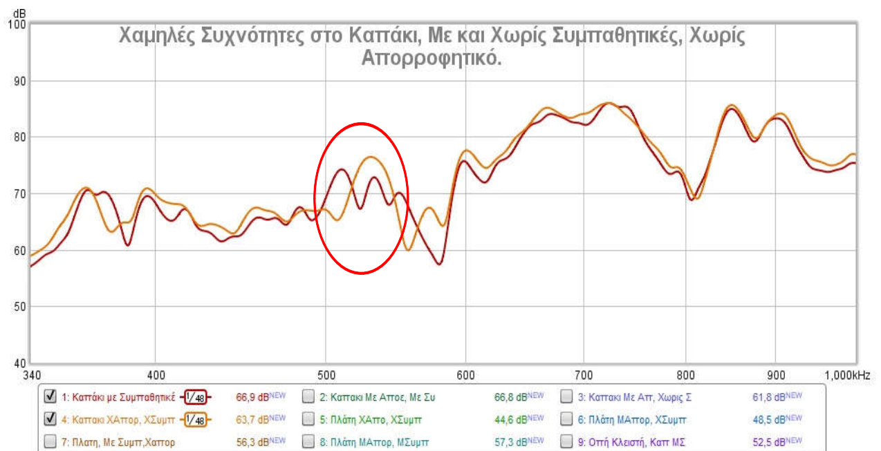
Εικόνα 29: Φάσμα χαμηλών συχνοτήτων από τον ηχοβολισμό του οργάνου στο καπάκι της λύρας με ενεργές και ανενεργές τις συμπαθητικές χορδές, χωρίς απορροφητικό υλικό. Το
