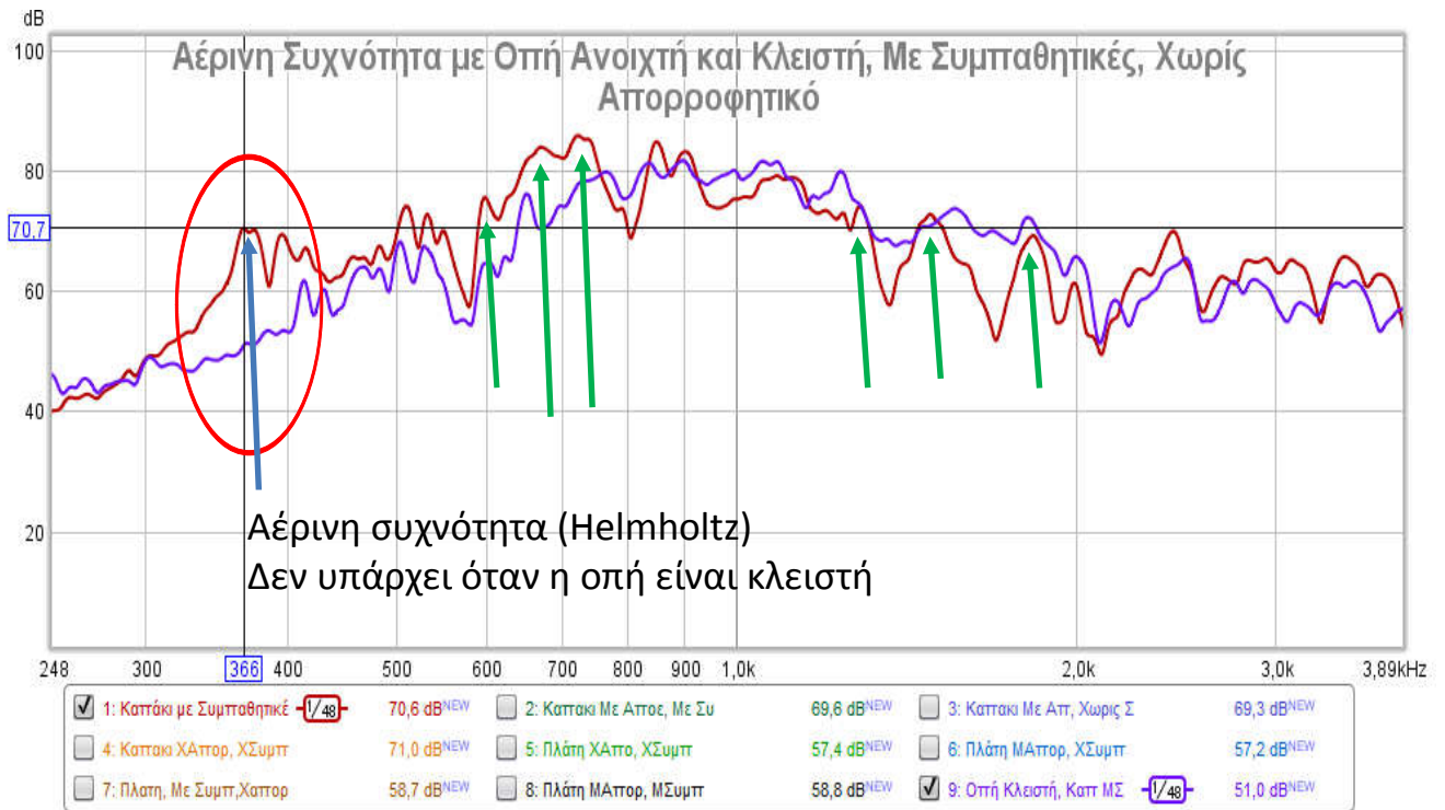
Εικόνα 38: Αέρια συχνότητα στα 366\text{Hz} όπως προκύπτει από τον ηχοβλοισμό του οργάνου στο καπάκι, με οπή κλειστή και ανοιχτή, με ενεργές τις συμπαθητικές χορδές, χωρίς απορροφητικό υλικό. Το κόκκινο χρώμα δείχνει το φάσμα με ανοιχτή οπή, ενώ το μωβ, με κλειστή οπή. Τα πράσινα βέλη δείχνουν τους «καθαρούς» συντονισμούς σε χαμηλές και μεσαίες συχνότητες ( < 2\text{kHz} ) όταν οι συμπαθητικές χορδές είναι ενεργές.
