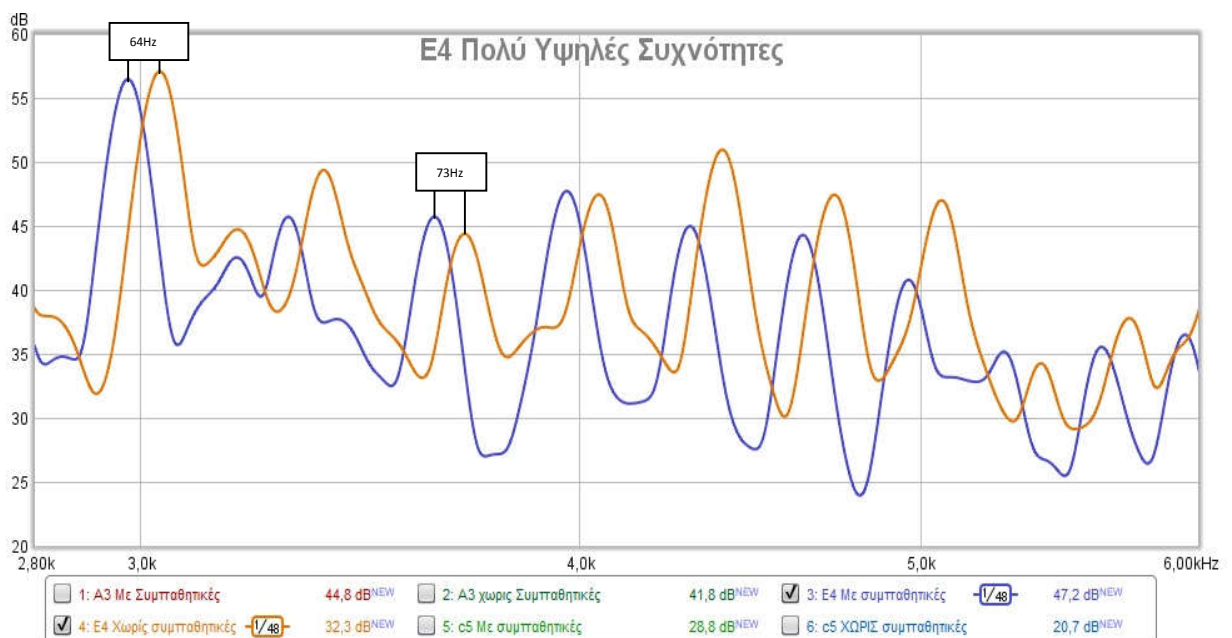
Εικόνα 24: Το φάσμα της νότας E_4 , στις πολύ υψηλές συχνότητες, με και χωρίς συμπαθητικές χορδές. Το κίτρινο χρώμα είναι με ανενεργές τις συμπαθητικές χορδές, ενώ το μπλε, με ενεργές τις συμπαθητικές χορδές. Παρατηρείται μετατόπιση προς χαμηλότερες συχνότητες.
