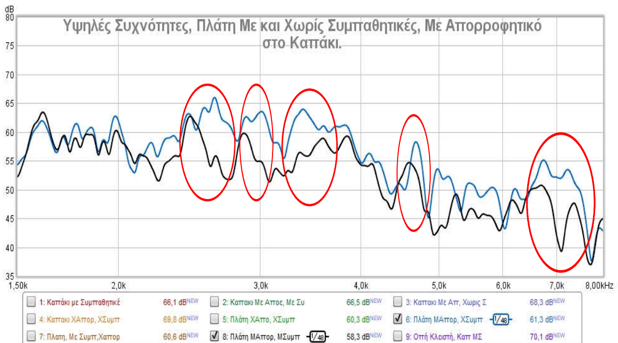
Εικόνα 36: Φάσμα υψηλών συχνοτήτων από τον ηχοβολισμό του οργάνου στην πλάτη με και χωρίς συμπαθητικές χορδές, με απορροφητικό στο καπάκι. Το μαύρο χρώμα είναι με ενεργές τις συμπαθητικές χορδές, ενώ το μπλε, με ανενεργές τις συμπαθητικές χορδές. Παρατηρούνται διαφορές στις μεσαίες (2,5-3,5kHz) συχνότητες με μετατόπιση χαμηλότερα ή μείωση πλάτους συντονισμών όταν οι συμπαθητικές χορδές είναι ενεργές.
