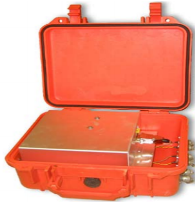
Εικόνα 15: MT όργανο μέτρησης MT-24LF
