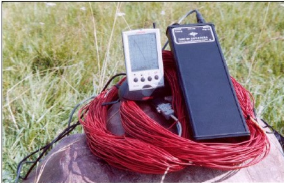
Εικόνα 14: όργανο μέτρησης TEM-FAST 48
