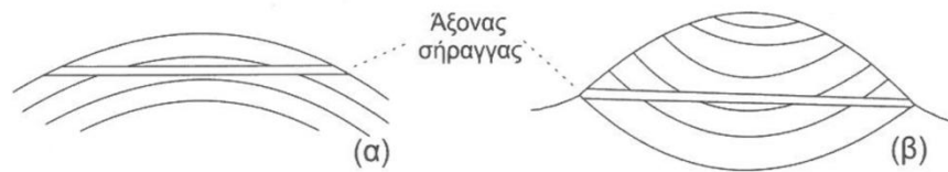
Σχήμα 10 : Σήραγγα που διατέμνει εγκάρσια (α) αντίκλινο και (β) σύγκλινο. (ΚΟΥΚΗΣ-ΣΑΜΠΑΤΑΚΑΚΗΣ).
