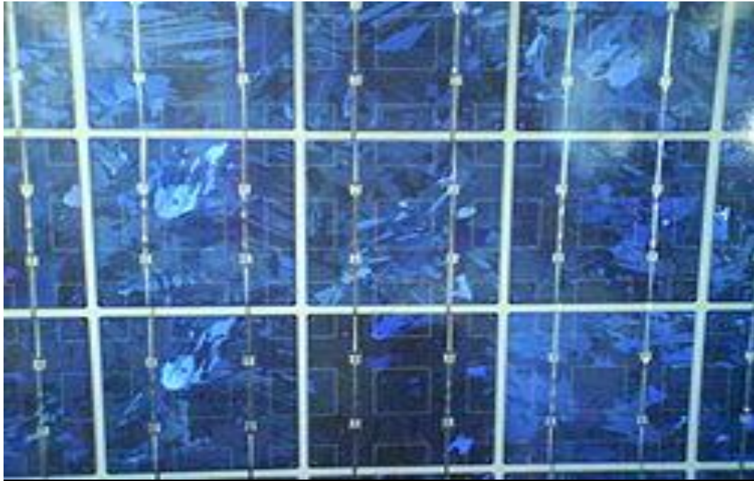
Εικόνα 9: Πολύ-κρυσταλλικό φωτοβολταϊκό πλαίσιο
