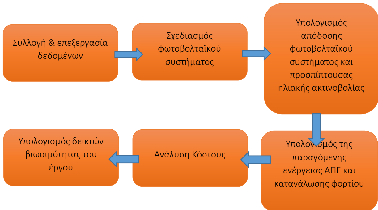
Εικόνα 1 Ενεργειακό μοντέλο φωτοβολταϊκού συστήματος
