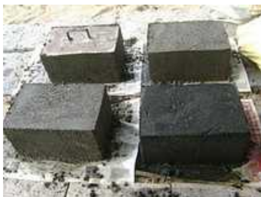
Εικόνα 10. Παραγωγή τούβλων από βιοεξανθράκωμα
