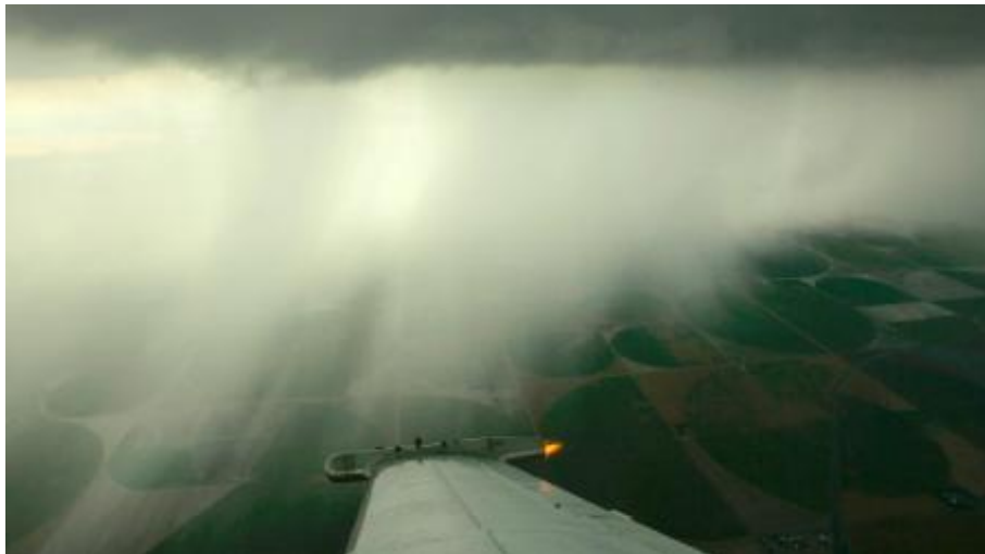
Εικόνα 12 Γεννήτρια σποράς νεφών εγκατεστημένη σε περὶμο αεροσκάφους κατά την διαδικασία σποράς νεφών, για το πρόγραμμα τροποποίησης καιρού του Δυτικού Κάνσας στις 28 Αυγούστου 2007, κοντά στο Lakin, Kan. Πηγή: (Roach, 2020)
