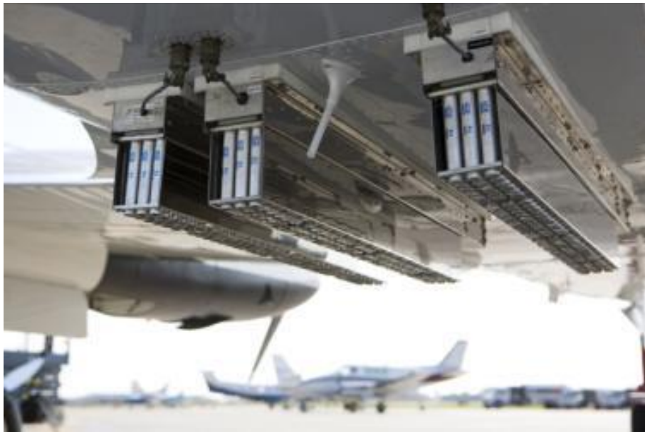
Εικόνα 10 Τεχνολογία ανάφλεξης της φωτοβολίδας σε συγκεκριμένη χωρική έκταση (Burn In Place Flares) εγκατεστημένη σε περὶγιο αεροσκάφους. Πηγή (Iceflares, 2021)
