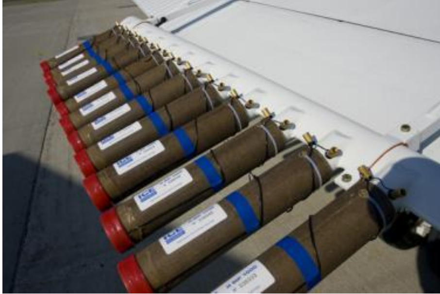
Εικόνα 9 Τεχνολογία εκτοξευόμενης φωτοβολίδας (Ejectable Flares) εγκατεστημένη σε περὶγιο αεροσκάφους. Πηγή: (Iceflares, 2020)
