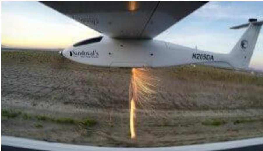
Εικόνα 13 Τεχνολογία εκτοξευόμενης φωτοβολίδας (Ejectable Flares) εγκατεστημένη σε ΣμηΕΑ σταθερής πτέρυγας Πηγή: (America, 2016)
