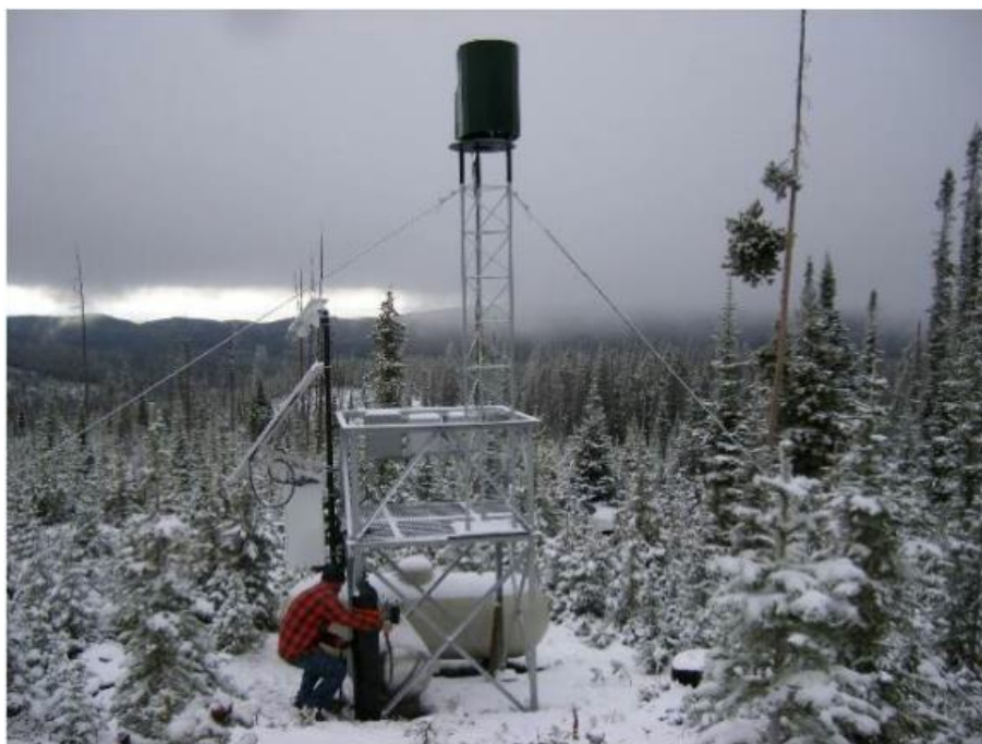
Εικόνα 16 Επίγεια γεννήτρια παραγωγής ιωδιούχου αργύρου και απελευθέρωσής του. Πηγή: (NAWMC, 2021)
