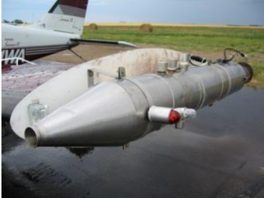
Εικόνα 11 Γεννήτρια σποράς νεφών εγκατεστημένη σε περὶμο αεροσκάφους. Πηγή: (NAWMC, 2021)
