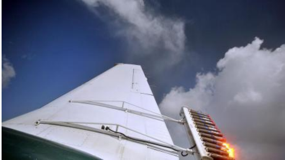
Εικόνα 14 Τεχνολογία ανάφλεξης της φωτοβολίδας σε συγκεκριμένη χωρική έκταση (Burn In Place Flares) εγκατεστημένη σε ΣμηΕΑ σταθερής πτέρυγας. Πηγή: (Haza, 2017)
