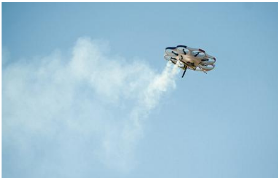
Εικόνα 15 Φωτογραφία από πειραματική εφαρμογή ΣμηΕΑ στην Νεβάδα, όπου χρησιμοποιήθηκε ένα ΣμηΕΑ με οκτώ κινητήρες και ολοκλήρωσαν επιτυχώς τις δοκιμές ψεκασμού των νεφών με ιωδιούχο άργυρο, Ιανουάριος 2016. Πηγή: (Zolfagharifard, 2016)
