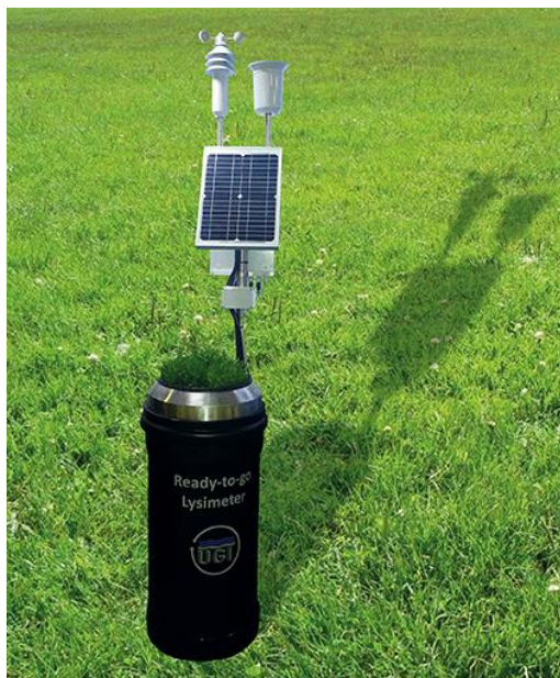
Εικόνα 34. Το Λυσίμετρο Ready-To-Go™, της εταιρείας UGT. Πηγή: UGT (2020)
