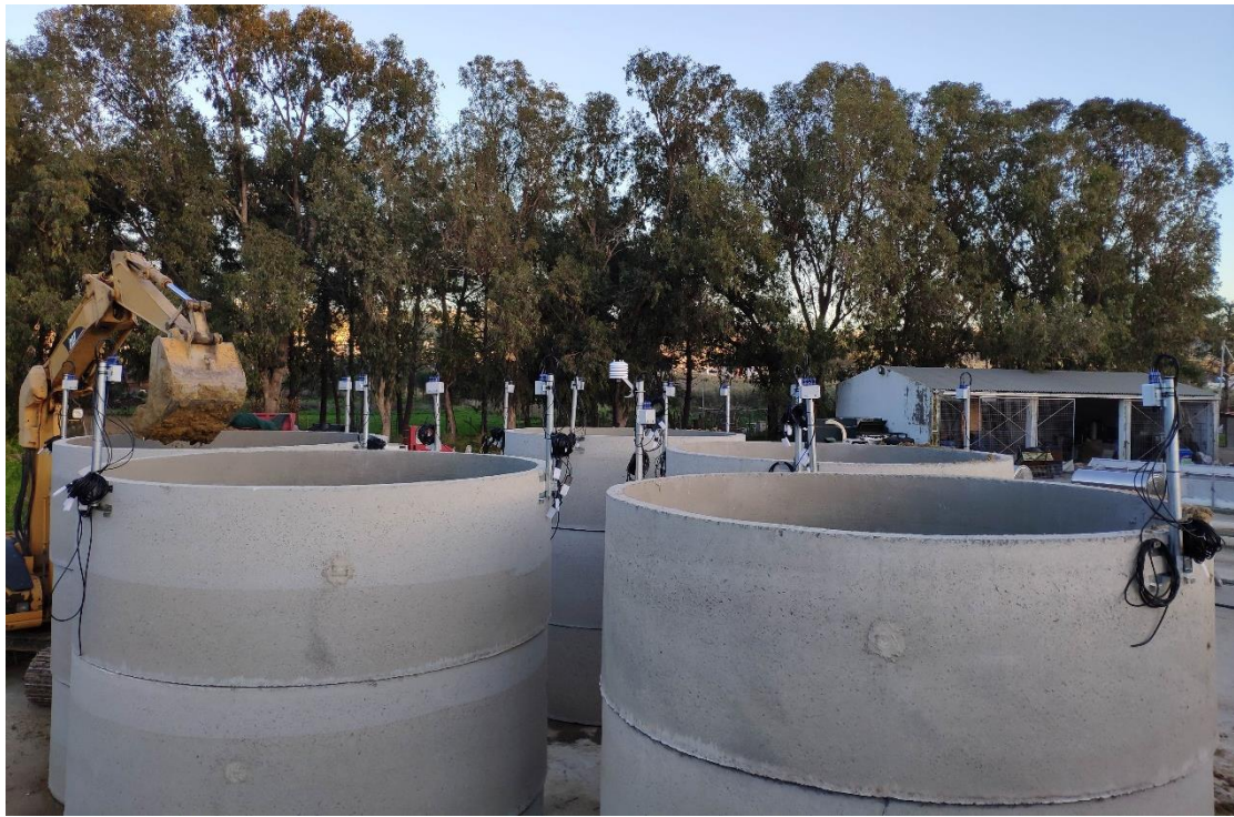
Εικόνα 41. Κόμβοι τοποθετημένοι στις δεξαμενές πριν την τοποθέτηση των δέντρων.
