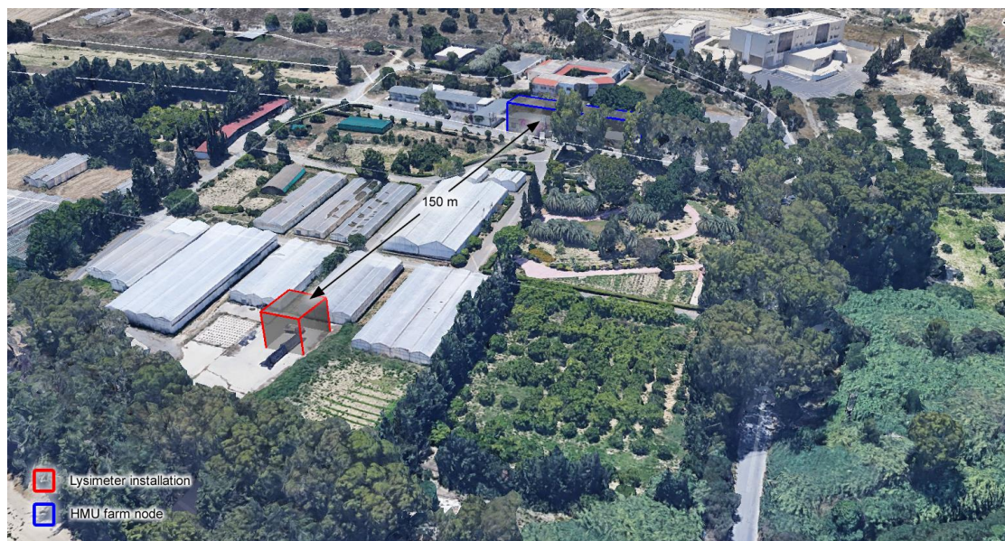
Εικόνα 42: Μετάδοση δεδομένων από τα λυσίμετρα στο edge-gateway. Πηγή Daliakopoulos et al. (2020).
