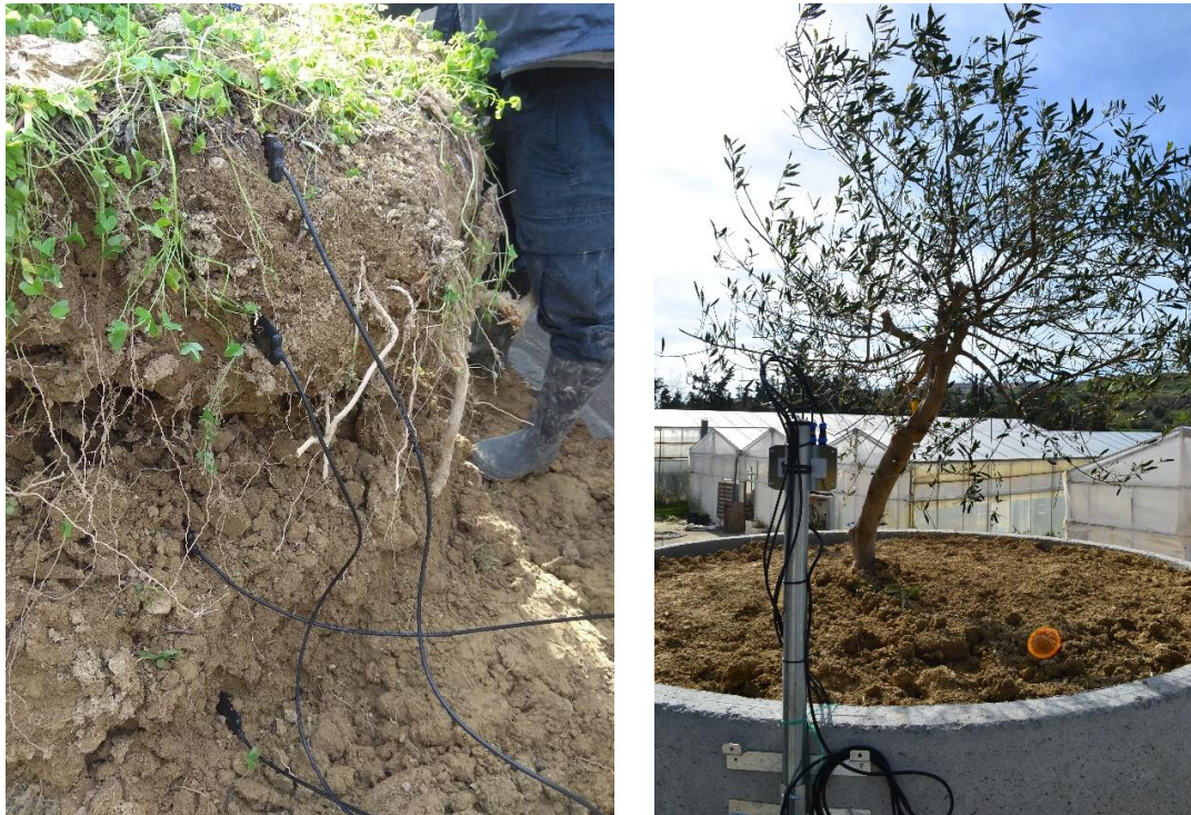
Εικόνα 43. Αριστερά: Τοποθέτηση των αισθητήρων. Δεξιά: Το λυσίμετρο με το δέντρο ελιάς
