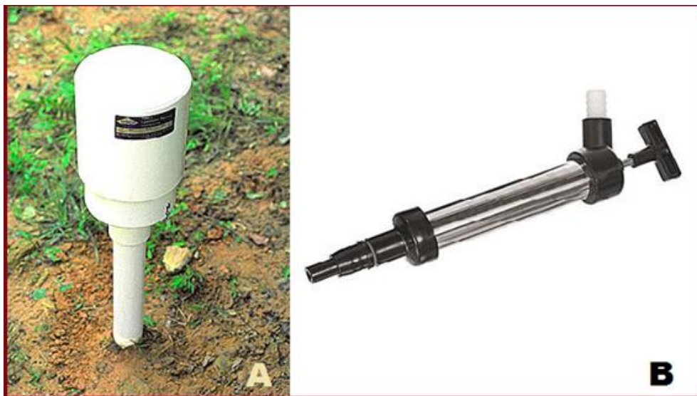
Εικόνα 32. A: Μυζητικό Λυσίμετρο Rickly™ B: Χειροκίνητη Αντλία. Πηγή: Rickly (2020)
