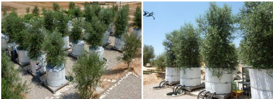
Εικόνες 30 & 31. Η ελεύθερη (εκτός εδάφους) διάταξη των ζυγιστικών-στραγγιστικών λυσίμετρων Πηγή: Ben-Gal et al. (2010)
