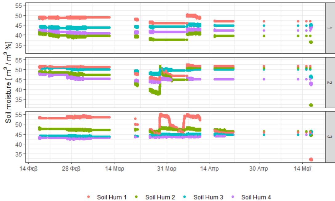
Εικόνα 48: Μετρήσεις εδαφικής υγρασίας για 4 βάθη (χρώματα) και 3 πλευρές του ελαιόδεντρου που βρίσκεται στο λυσίμετρο 1 για το διάστημα Φεβρουάριος-Μάιος 2019.
