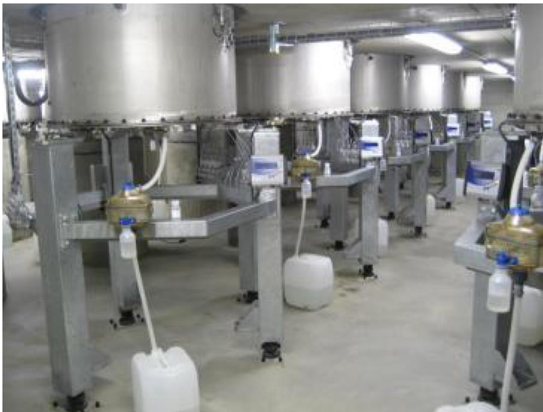
Εικόνα 19. Τα ζυγιστικά Λυσίμετρα διατεταγμένα στον υπόγειο χώρο κάτω από το αγρόκτημα, Πηγή: Prasuhn et al. (2016).
