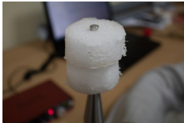
Εικόνα 5.1.4.6: Το μικρόφωνο τοποθετήθηκε μέσα στο πώμα για καλύτερα αποτελέσματα μετρήσεων
