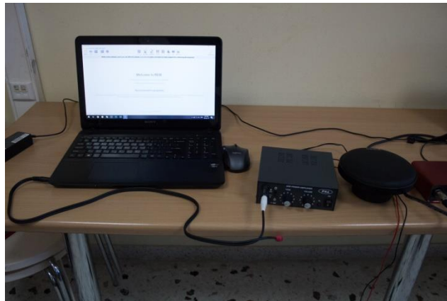
Εικόνα 5.1.1.1: Ηλεκτρονικός υπολογιστής συνδεδεμένος με ενισχυτή και ηχείο για αναπαραγωγή συχνοτήτων.
