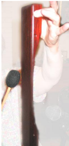
Εικόνα 7.6.1.3: Τεχνική διέγερσης του τρίτου εγκάρσιου τρόπου
