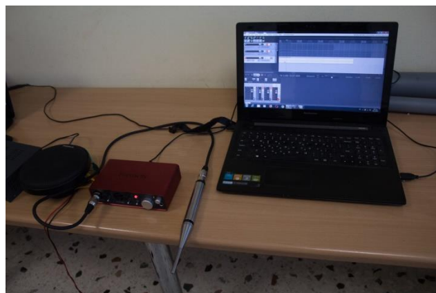
Εικόνα 5.1.1.2: Ηλεκτρονικός υπολογιστής συνδεδεμένος με κάρτα ήχου και μικρόφωνο για την καταγραφή των συντονισμών του σωλήνα.
