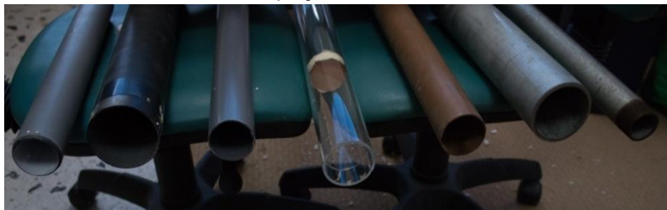
Εικόνα 5.2.1: Οι σωλήνες που χρησιμοποιήθηκαν από αριστερά προς δεξιά, λάστιχο Φ50, πλαστικό Φ50, πλαστικό Φ75, πλεξιγκλάς Φ60, χαλκός Φ50, γαλβανιζέ Φ65, γαλβανιζέ Φ34.
