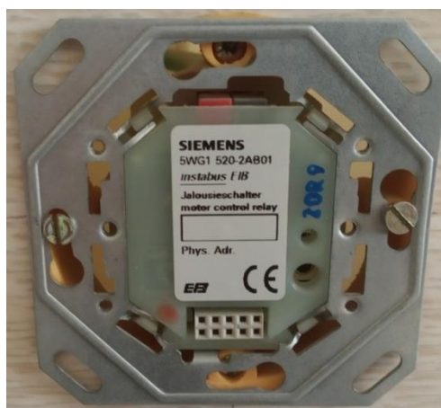
Εικόνα 58. Προσαρμοστής Bus (BCU) της εταιρείας Siemens για έλεγχο κινητήρων
