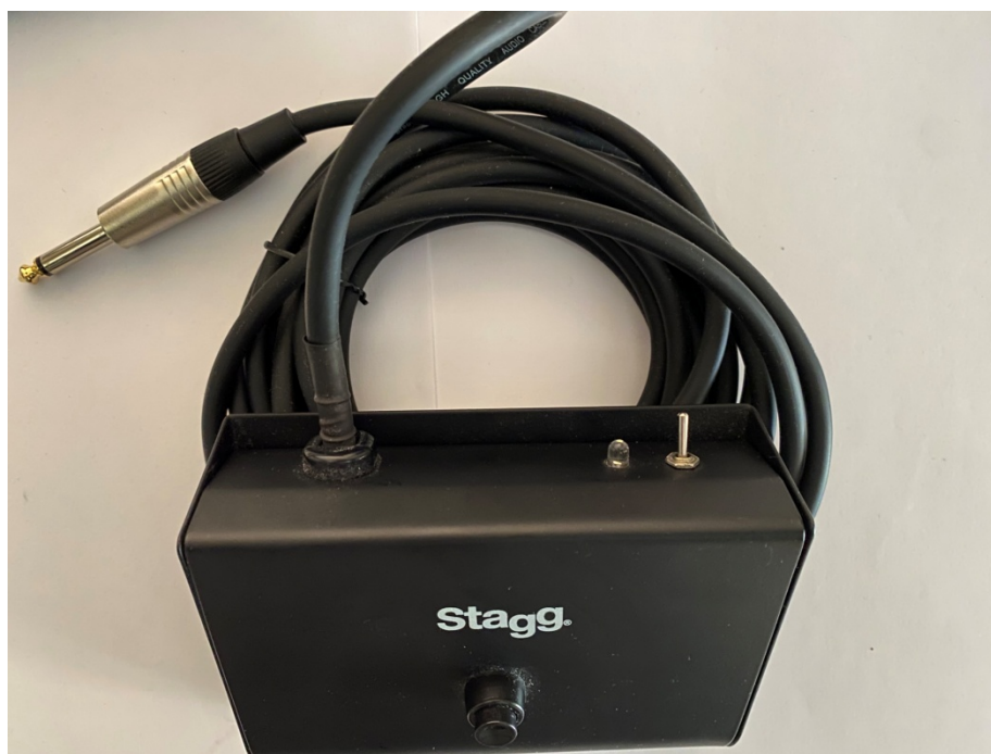
Εικόνα 5: Ο μετασκευασμένος πλέον ποδο-διακόπτης με ενσωματωμένο το κύκλωμα μετατροπής.
