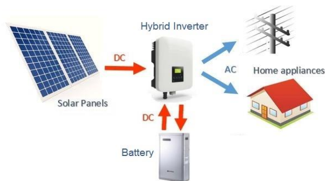
Εικόνα 22: Συνδεσμολογία υβριδικού ΦΒ συστήματος από την παραγωγή ηλ. Ρεύματος μέχρι την κατανάλωση και το δίκτυο
