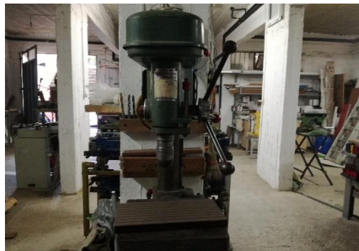
Εικόνα 64: Μηχανή γεώτρησης Πάγκου ισχύος 370W
