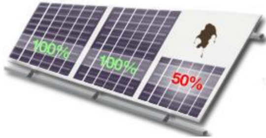
Εικόνα 49: Σύνδεση ενός μικρό-μετατροπέα σε κάθε ηλιακό πλαίσιο η σκίαση ενός δεν επηρεάζει ολόκληρη τη συστοιχία θα επηρεάσει μόνο τα λερωμένα πάνελ.
