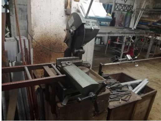
Εικόνα 62: Δισκοπρίνο Μετάλλων ισχύος 1.8 kW
