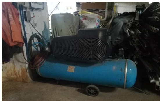
Εικόνα 61: Κομπρεσέρ Αέρος ισχύος 4 kW
