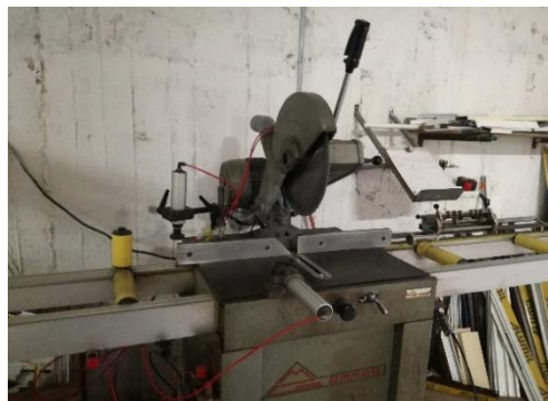
Εικόνα 63: Δισκοπρίνο Αλουμίνιου ισχύος 1.8kW
