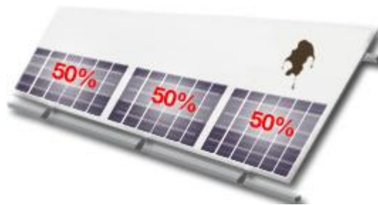
Εικόνα 48: Ηλιακά πάνελ συνδεδεμένα σε σειρά και η σκίαση ενός επηρεάζει δραματικά ολόκληρη τη συστοιχία.
