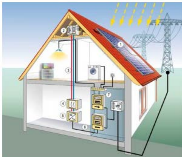
Εικόνα 22: Τρόπος λειτουργίας αυτοπαραγωγής με ενεργειακό συμψηφισμό
