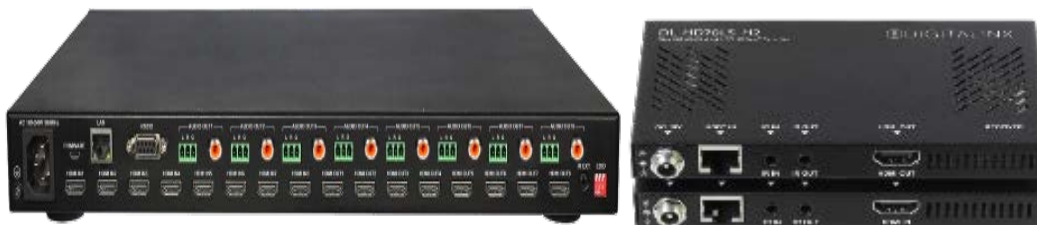
Εικόνα 27: Διανομέας εικόνας και μετατροπείς σήματος
